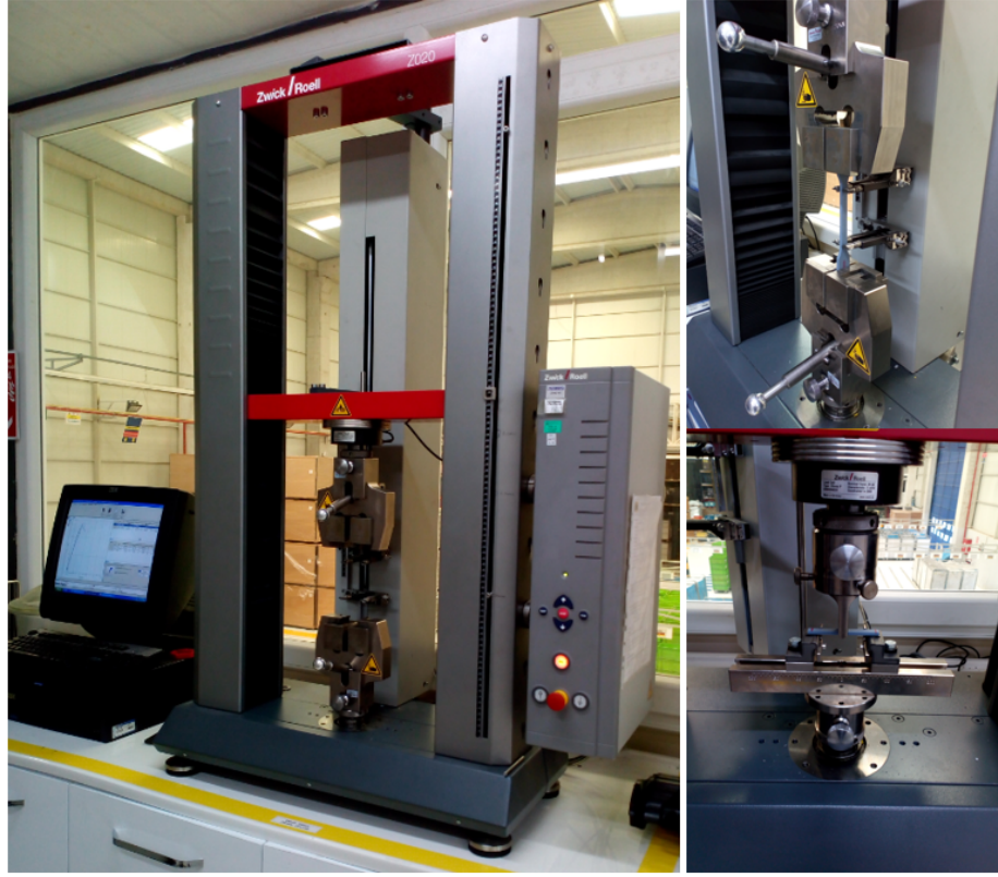
Şekil 3.5. Çekme ve eğme testlerinde kullanılan Universal Zwick/RoellZ020 çekme cihazı
