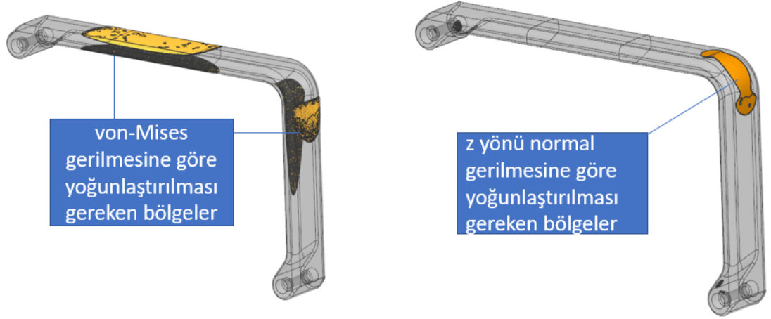
Şekil 3.11. 400 N açılı yük için kolçak modelinin yoğunlaştırma ihtiyacı olan bölgeleri (von-Mises 5 MPa ve üzeri, z normal 0,4 MPa ve üzeri gerilme bölgeleri)
