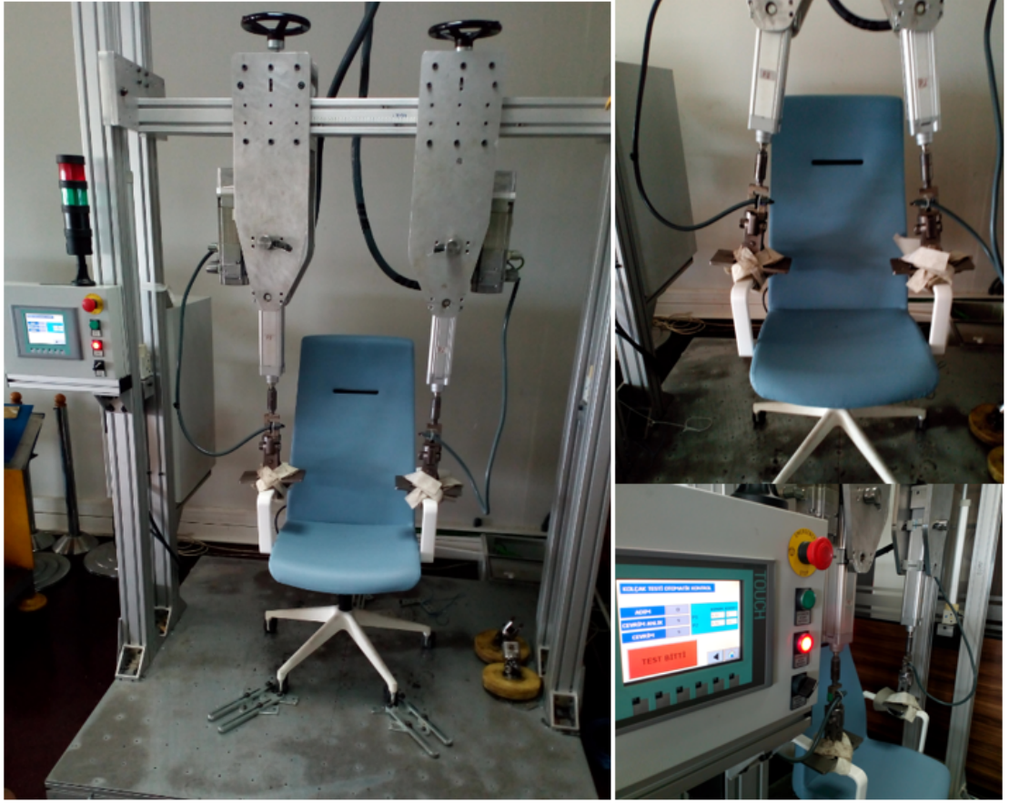
Şekil 3.16. TS EN 1335 kolçak dik, ön ve açılı test uygulama cihazı (Ermetal A.Ş. - Arge Merkezi Ofis Mobilyaları Test Laboratuvarı)
