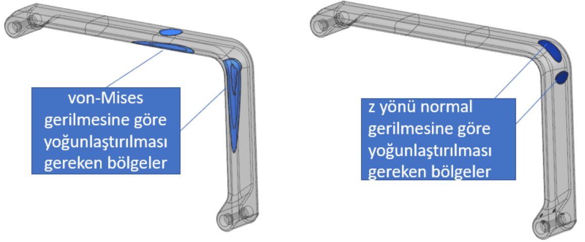
Şekil 3.9. 450 N ön yük için kolçak modelinin yoğunlaştırma ihtiyacı olan bölgeleri (von-Mises 5 MPa ve üzeri, z normal 0,4 MPa ve üzeri gerilme bölgeleri)
