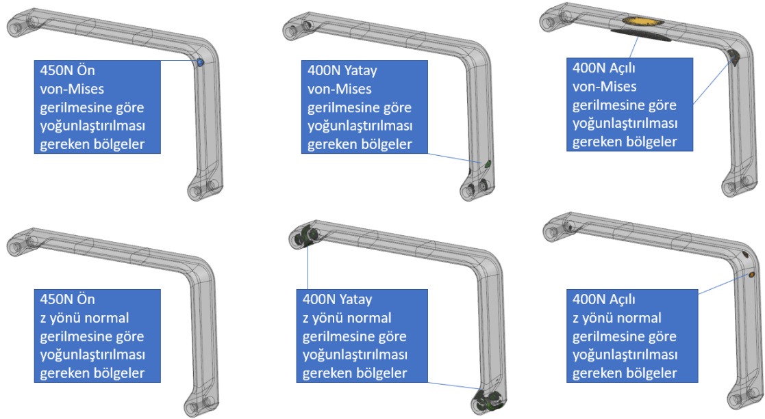
Şekil 3.8. 450 N ön, 400 N açılı ve 400 N yan yük için kolçak modelinin yoğunlaştırma ihtiyacı olan bölgeleri (von-Mises 8 MPa ve üzeri, z normal 0,7 MPa ve üzeri gerilme bölgeleri)
