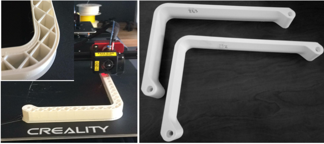
Şekil 3.13. Optimize edilmiş kolçak modelinin FDM yöntemi ile üretimi
