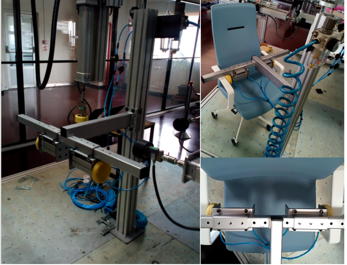
Şekil 3.15. TS EN 1335 kolçak içten açma test cihazı (Ermetal A.Ş. - Arge Merkezi Ofis Mobilyaları Test Laboratuvarı)
