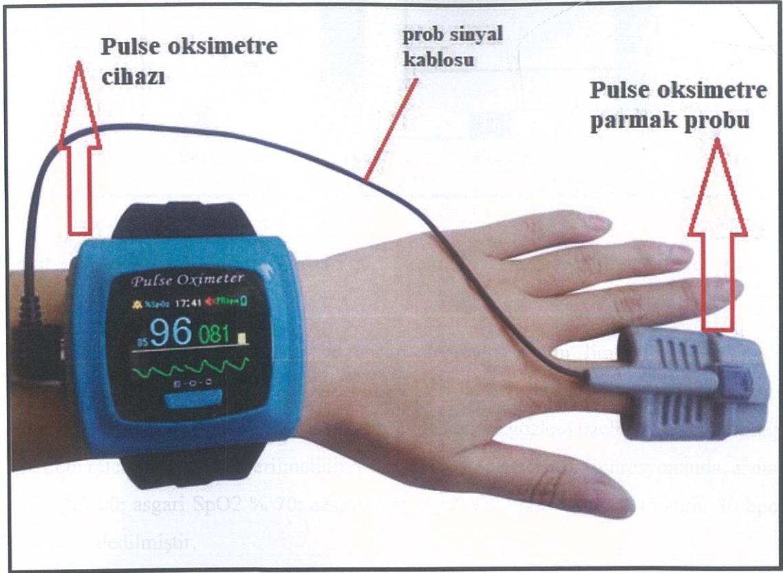
Şekil 3.2. Sistemde kullanılan pulse oksimetre cihazı ve bileşenleri
