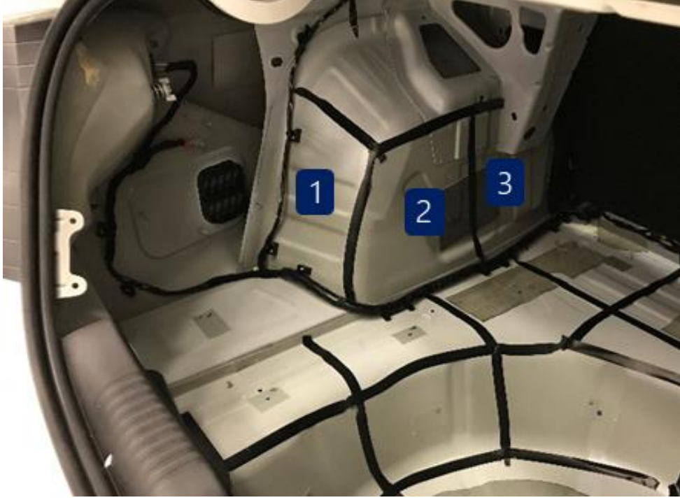
Şekil 4.7. Sol arka çamurluk paneli ve panelcikleri
