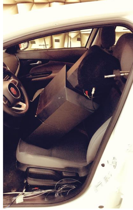
Şekil 4.21. Akustik transfer fonksiyonu ölçümlerinde frekans hacim kaynağının yerleşimi
