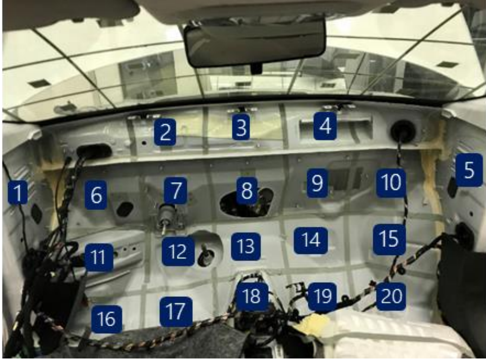
Şekil 4.1. Ön Göğüs Paneli ve alt panelcikleri
