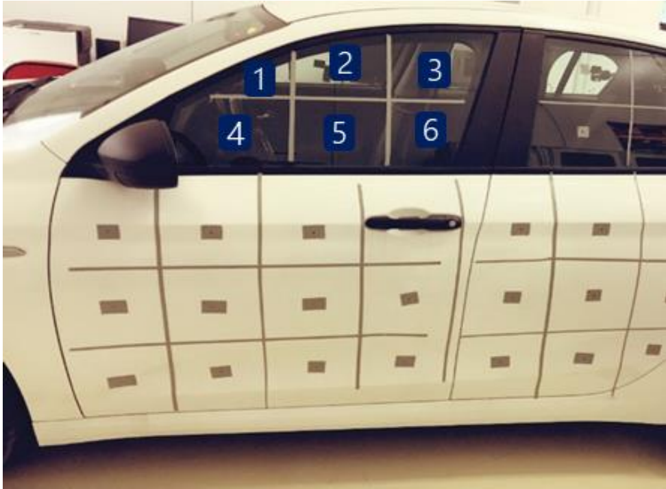
Şekil 4.14. Ön sol kapı camı paneli ve panelcikleri
