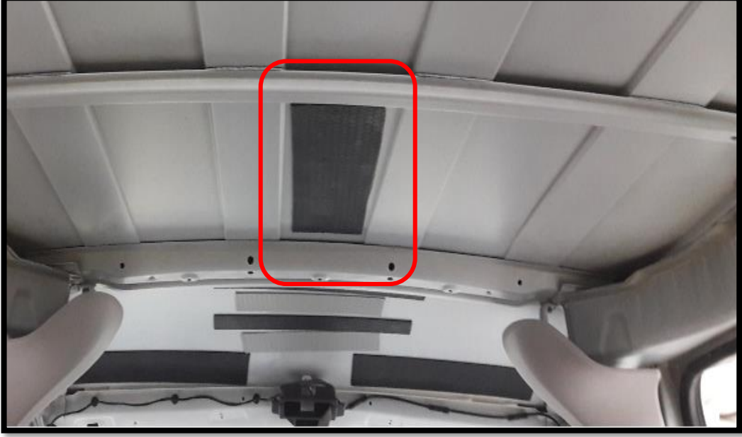
Şekil 4.34. Örnek bir yapısal sönüm elemanı uygulaması
