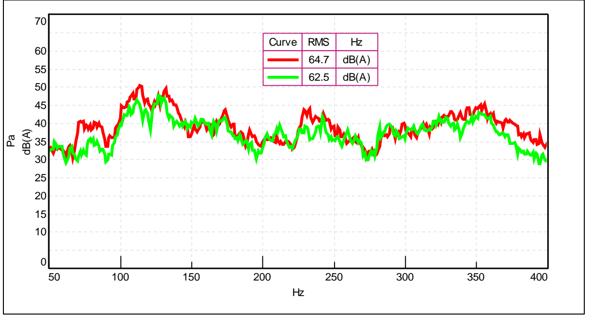
Şekil 4.35. Uygulanan iyileştirme çalışması ile ilk durumun karşılaştırılması
