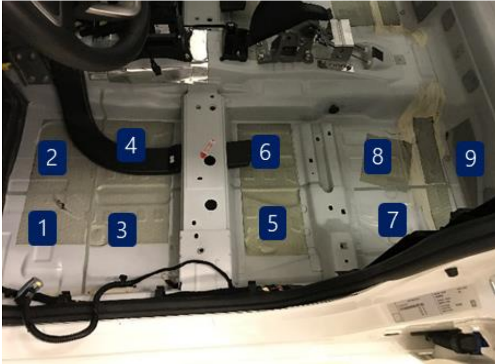
Şekil 4.2. Ön Sol Taban Paneli ve alt panelcikleri
