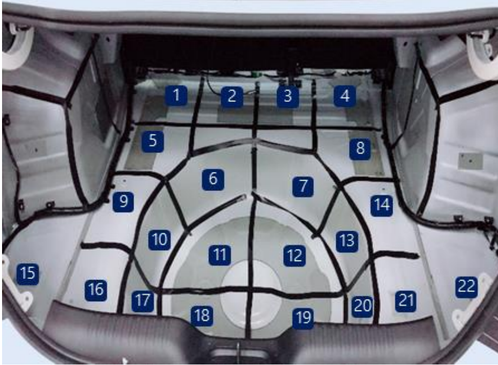
Şekil 4.6. Bagaj taban paneli ve panelcikleri
