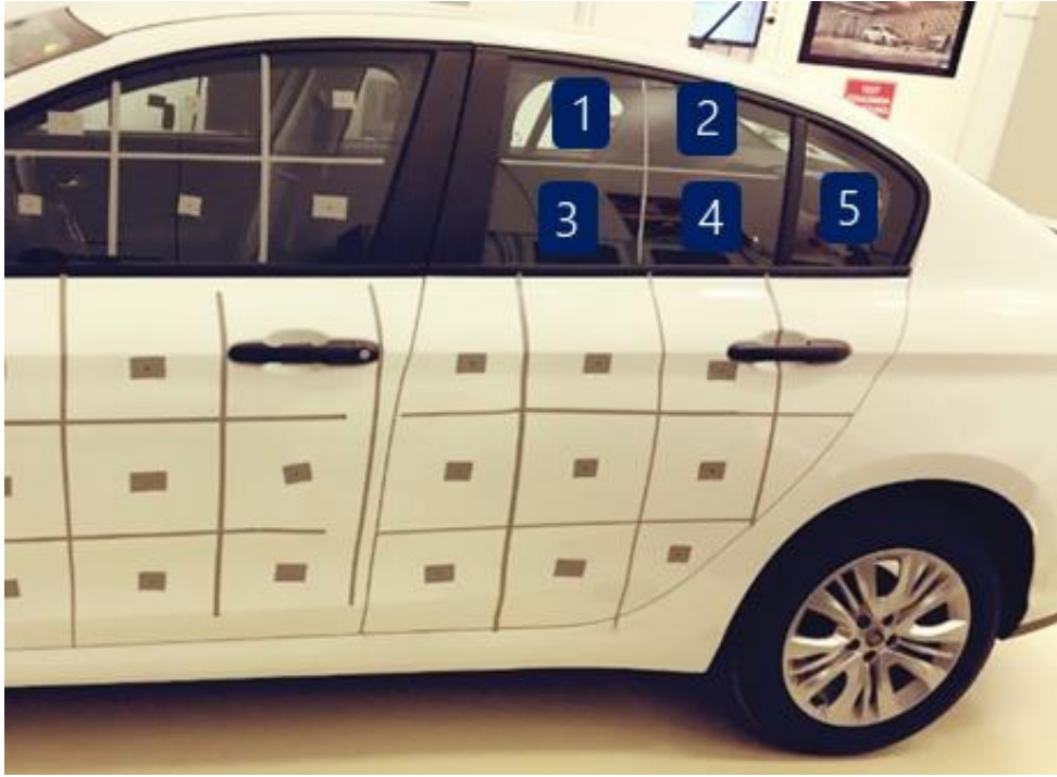
Şekil 4.18. Arka sol kapı camı paneli ve panelcikleri
