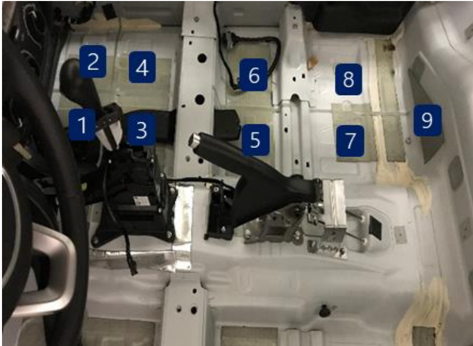
Şekil 4.4. Ön sağ taban paneli ve alt panelcikleri
