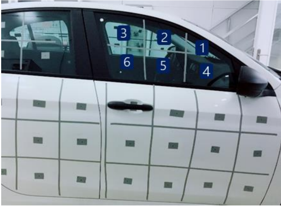
Şekil 4.16. Ön sağ kapı camı paneli ve panelcikleri
