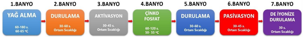
Şekil 2.2. Tipik çinko fosfatlama hattı sıralaması
