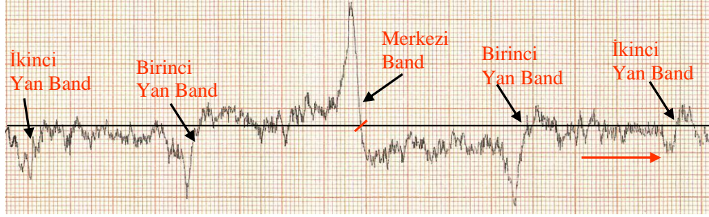
Şekil 3.14. Spektrometreden elde edilmiş olan P 0 sinyali (MC800 asfalt (dip)/benzen – 34,3 kg/m 3 , I 0 = 2.01998 A D.C. Ön yükselteç 1/1, kademe-6, tarama genliği kademe-10, sinüs modülasyon genliği: 1,51 mA, Q-metre: kademe-5/35 µA, kuartz titreşici: kademe-5/20 µA, delay: 1/16, faz duyarlı det.: τ = 5,64 s, Tarama Süresi: 800 s, kaydedici: Y 1 = 1 V/cm, Time Base: T = 50 s/cm)
