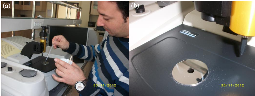
Şekil 4.14. FT-IR ölçümüne hazırlık a) Sıvı fazdaki petrol numunesi örnek gözüne damlatıldı b) Cihazın aparatı ile sıkıştırılarak ölçüme hazır hale getirildi
