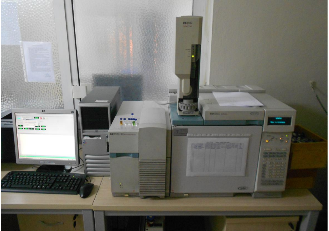
Şekil 3.7. Analizlerin yapıldığı Agilent 6890/5973N gaz kromatografisi–kütle spektrometresi.
