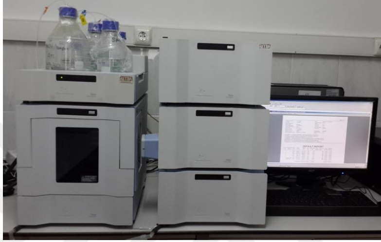
Şekil 3.1. Perkin Elmer Flexar™ HPLC cihazı
