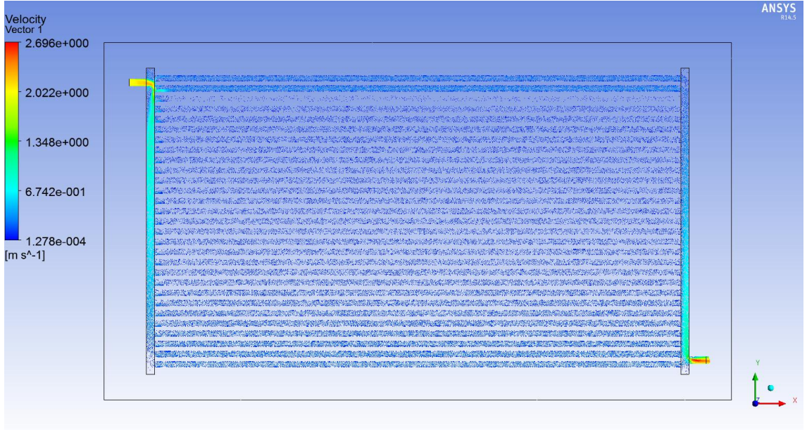
Şekil 4.2. 13.88 m/s hızındaki hava girişi için akışın vektör gösterimi
