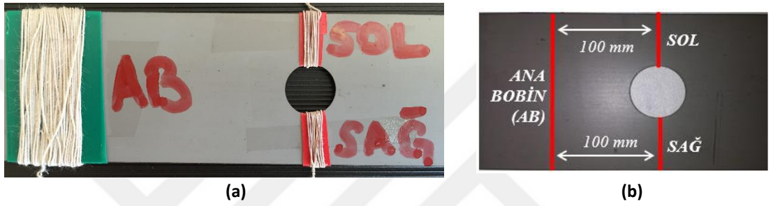
Şekil 3.12. Ortalama akı doğrultusuna dik bağlanan Ana Bobin (AB), Sağ ve Sol bobinler, hem fotoğraf (a) ile hem de ölçeklendirilen şemasıyla (b) gösterilmiştir.
