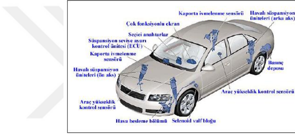
Şekil 2.4 Aktif süspansiyon sistemi elemanları ve araç üzerindeki yerleri (MEB, 2013)
