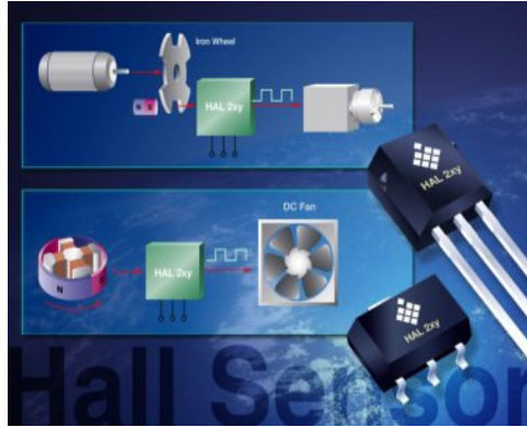
Şekil 1.8. Hall Algılayıcısı ( www.sensorportal.com )
