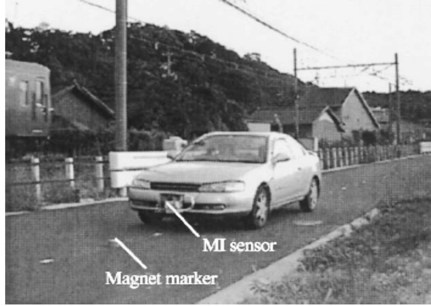
Şekil 1.10. GMI algılayıcı kullanılarak çalışan manyetik izleme sistemi (Phan, 2007)
