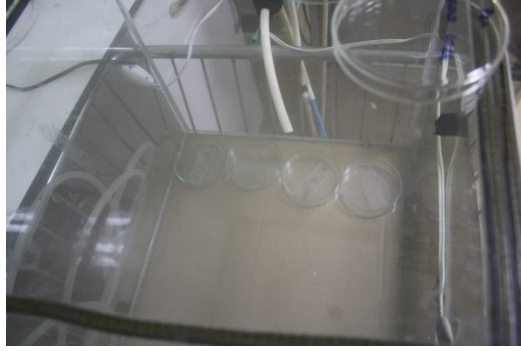
Şekil 3.6. İçerisine spor yayılmış lamellerin konulduğu petrilere dezenfektan uygulaması yapılması için steril sızdırmaz cam kabin içerisine konulması
