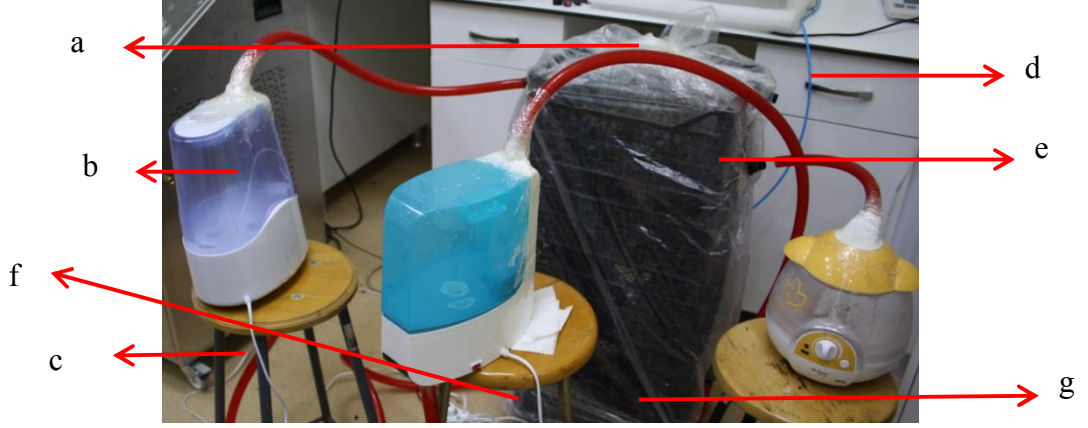
Şekil 3.4. a) Polietilen örtü b) Ultrasonik sisleyici c) Ozon gazının verilmesini sağlayan hortum d) Analizör sensörü e) Meyve kasaları f) Tahliye hortumu g) Fan
