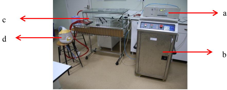
Şekil 3.3. In vitro çalışmasının yapıldığı sızdırmaz cam kabin sistemi; a) Ozon analizörü b) Ozon jeneratörü c) Cam kabin d) Ultrasonik sisleyici
