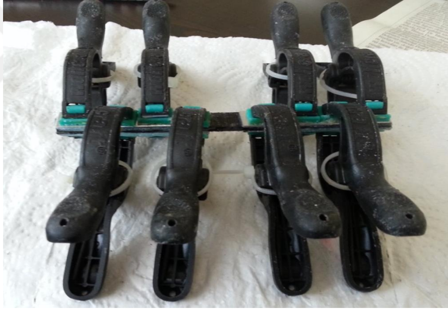
Şekil 7.10. Basma numuneleri end-tab hazırlanması
