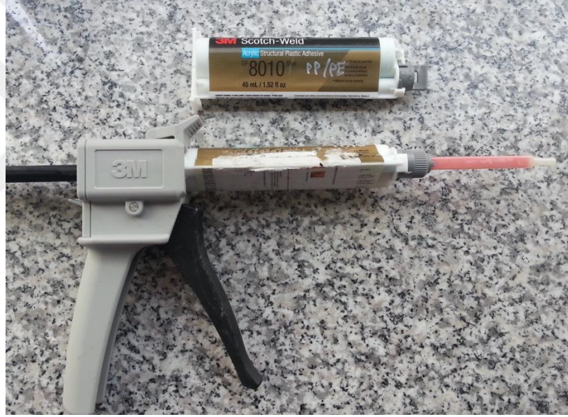
Şekil 7.1. Çekme ve basma deney tablaları için kullanılan yapıştırıcılar
