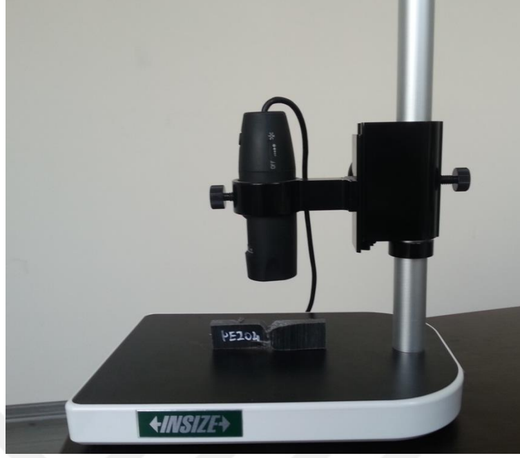
Şekil 7.2. Deney sonrası numunelerin incelendiği dijital mikroskop
