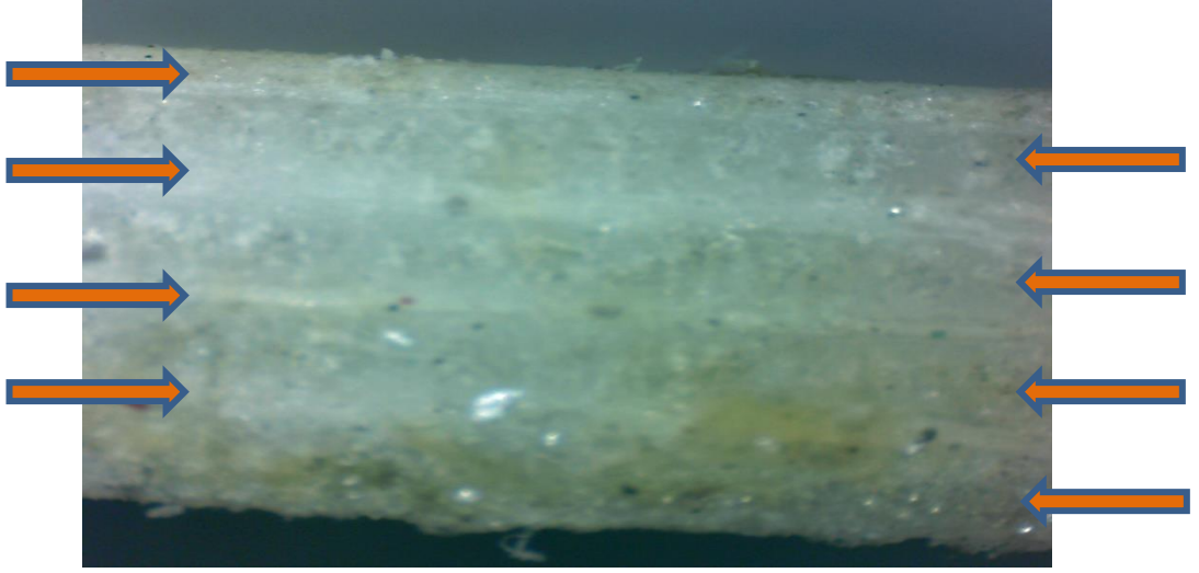
Şekil 7.9. Basma deney numunelerinin 0/90 doğrultulu 8 katmanlı lamina düzeni
