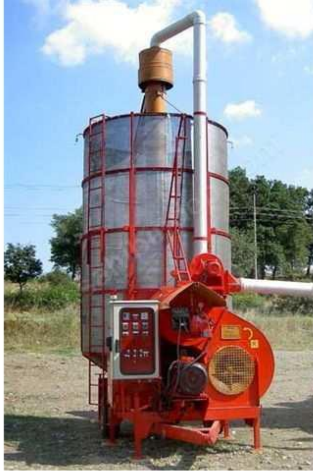
Şekil 2.1. Depo tipi eltik kurutucu
