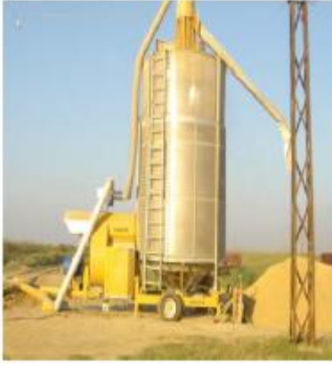
Şekil 2.2. Denemelerde kullanılan farklı kapasitelerdeki depo tipi kurutma sistemleri
