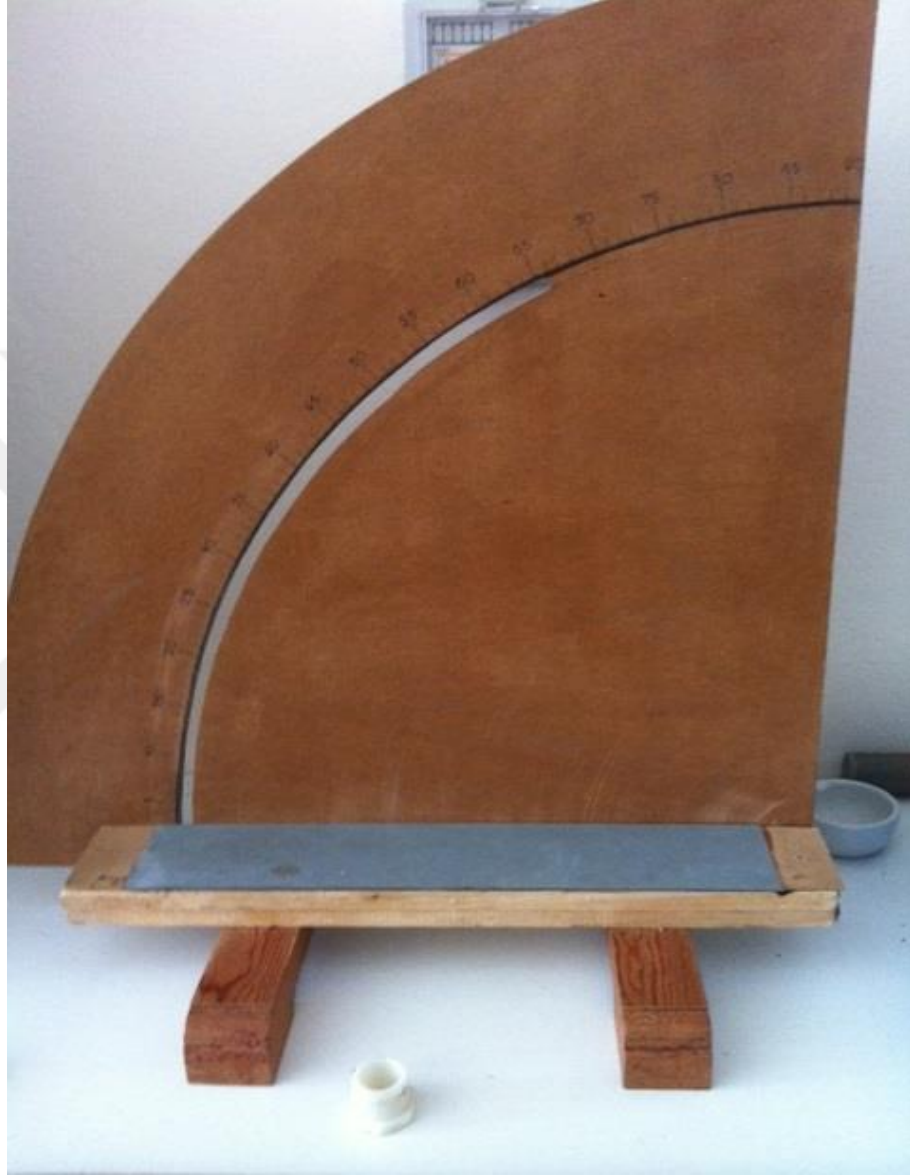
Şekil 3.10. Çeltik tanelerinin yuvarlanma açısı belirleme deney düzeneği görünüşü
