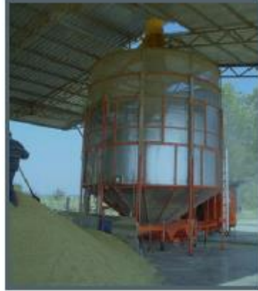
Şekil 2.2. Denemelerde kullanılan farklı kapasitelerdeki depo tipi kurutma sistemleri
