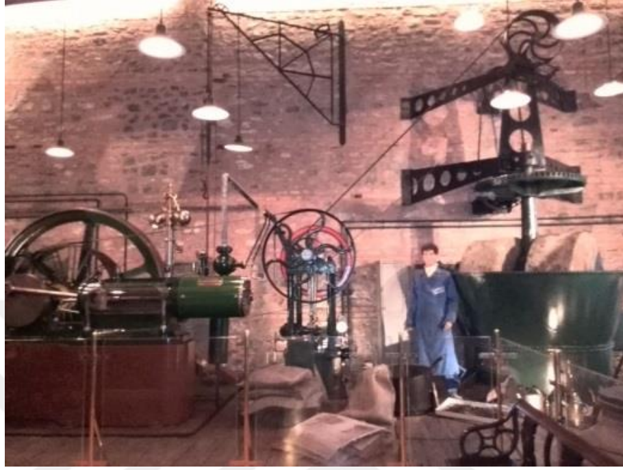
Şekil 3.8. İstanbul Rahmi Koç Müzesi'nde zeytinyağı fabrikası sergisi, buhar enerjisini hareket enerjisine dönüştüren buhar makinesi ve taş değirmen
