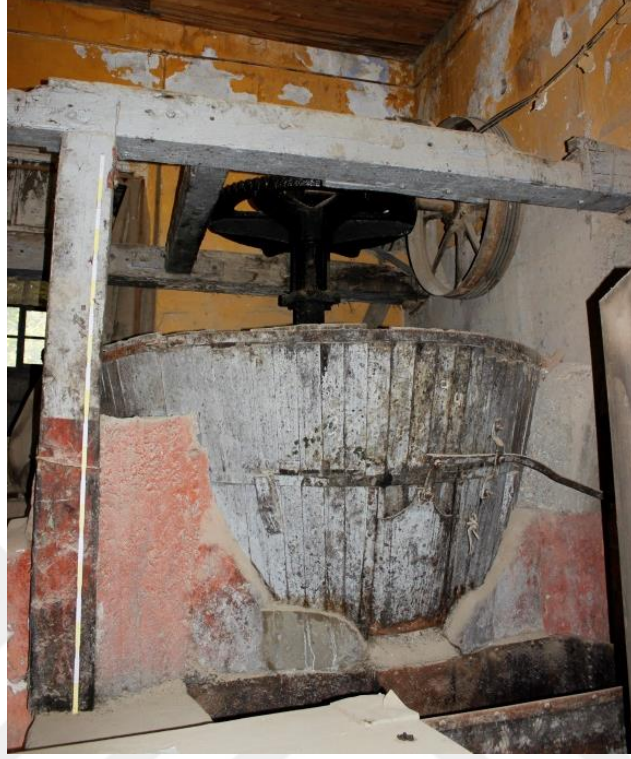
Şekil 6.14. Zeytinin ezilip hamur haline getirildiği değirmen
