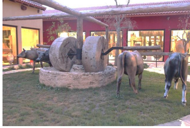
Şekil 4.7. Zeytini ezmekte kullanılan Trapetum – taş değirmen (Kaynak: http://www.oleatrium.com 2015)
