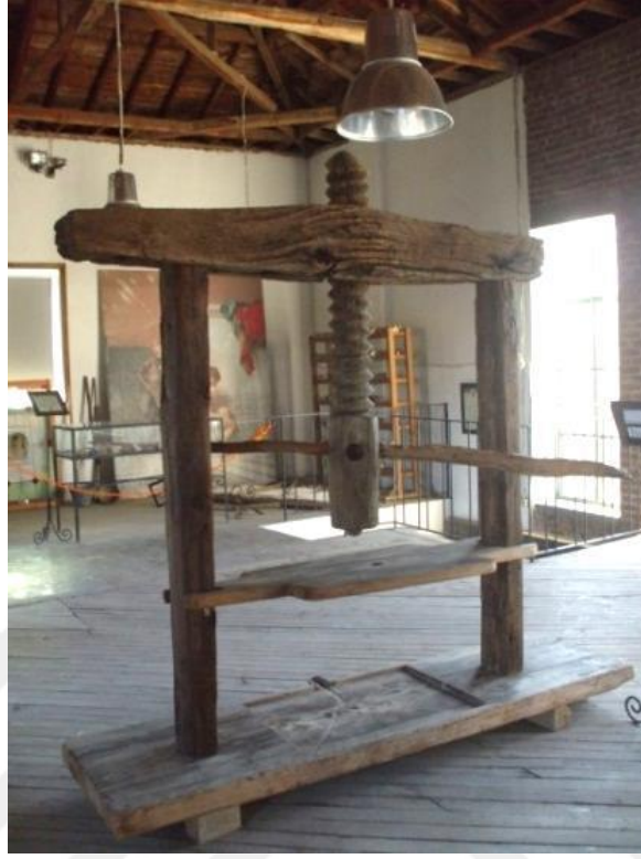
Şekil 3.2. Adatepe Zeytinyağı Müzesi – sonsuz vidalı ahşap pres, 2010
