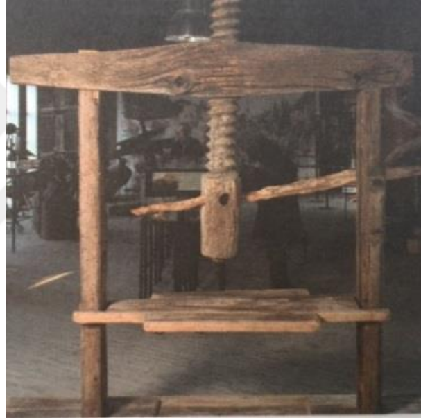
Şekil 4.9. Zeytinyağı çıkarmada kullanılan sonsuz vidalı ahşap pres (Boynudelik ve Boynudelik 2007)
