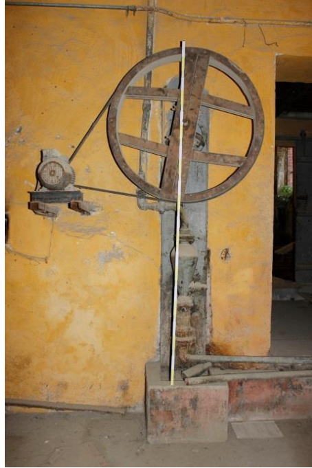
Şekil 6.17. Hidroliklere su gönderen pompa
