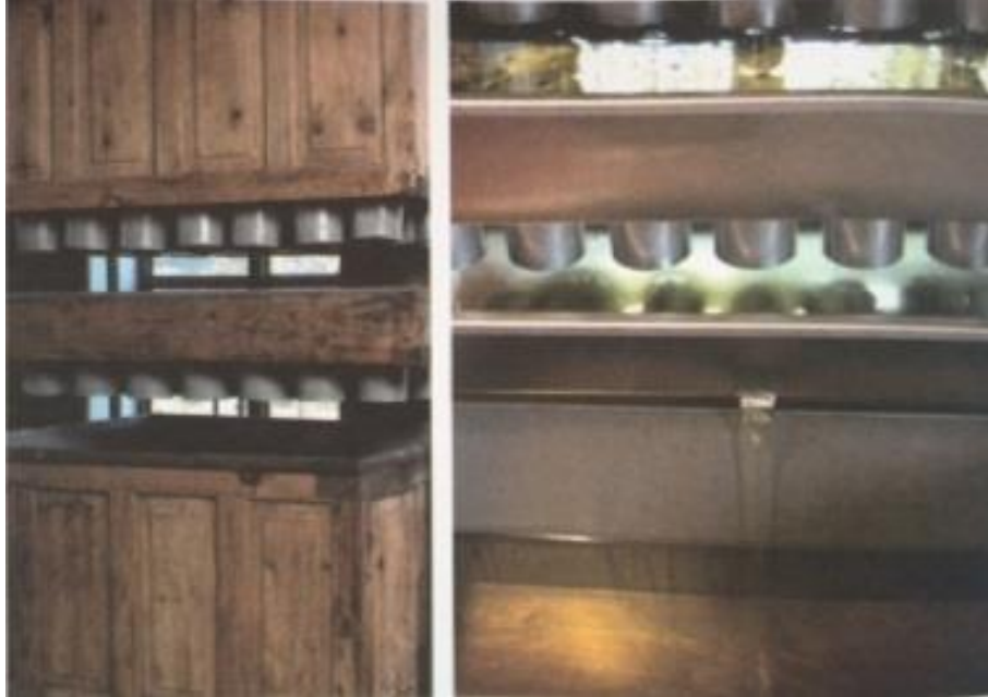
Şekil 4.12. Zeytinyağının tortulardan arındırıldığı filtre düzeneği (Boynudelik ve Boynudelik 2007)
