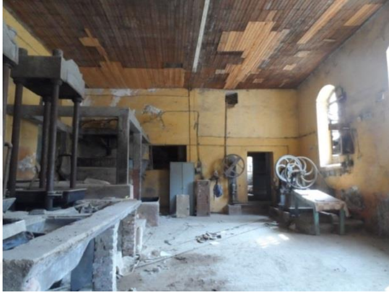
Şekil 6.10. Z01 Yağhane – taş değirmen, hidrolikler, hidrolik presler
