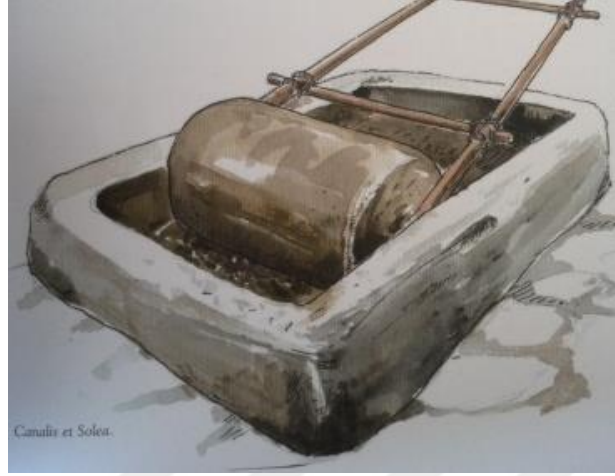
Şekil 4.5. Zeytini ezmekte kullanılan Canalis et Solea – taş değirmen (Boynudelik ve Boynudelik 2007)
