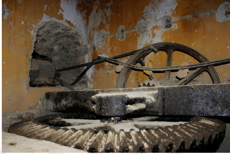
Şekil 6.16. Elektrikle çalışan ve değirmeni döndüren düzenek
