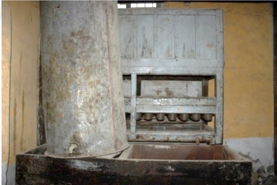
Şekil 6.24. Z02 Filtre odası – zeytinyağı filtreleme düzeneği
