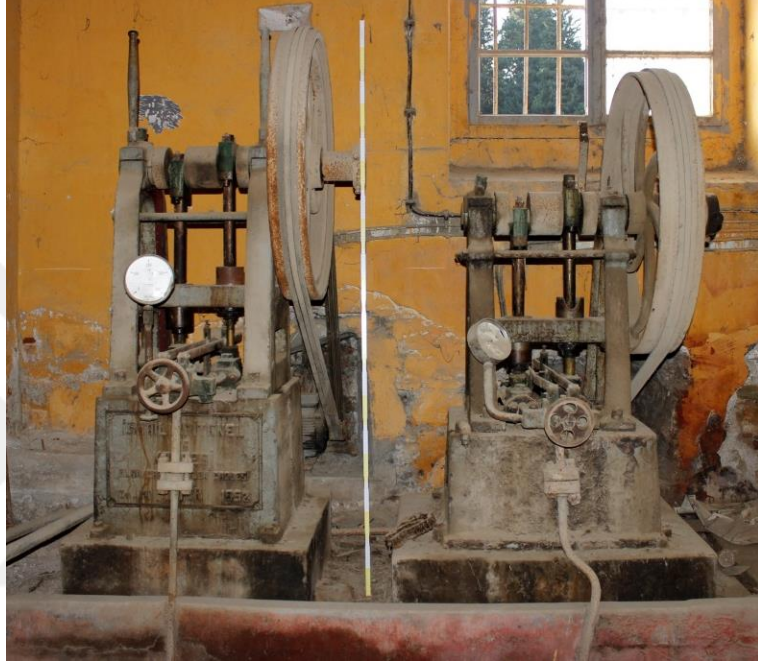
Şekil 6.18. Hidroliklere su gönderen pompa ve presleri kaldıran hidrolikler
