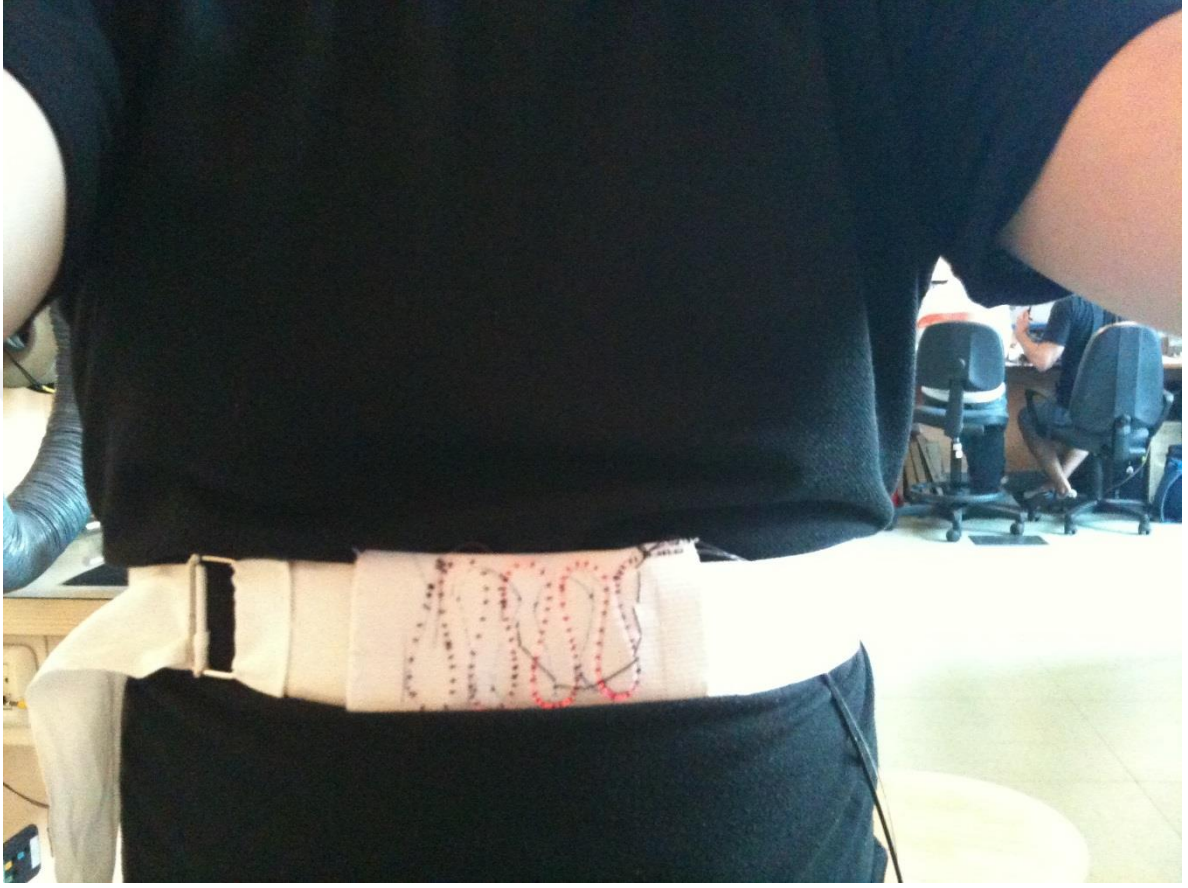
Şekil 4.16. Nefes sensörünün insan vücudunda denenmesi
