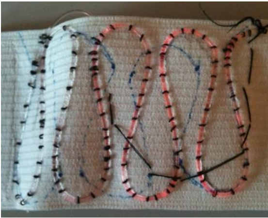
Şekil 4.11. Kemerin esnek kısmında yer alan nefes sensörü
