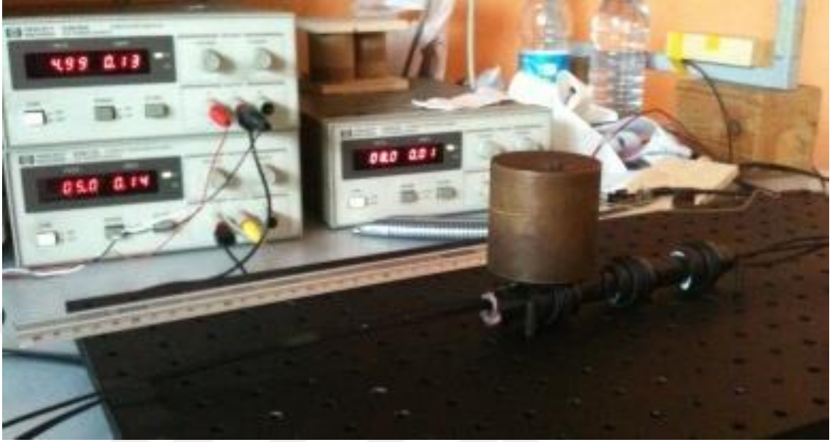
Şekil 4.24. Sarma sensörü test düzeneği
