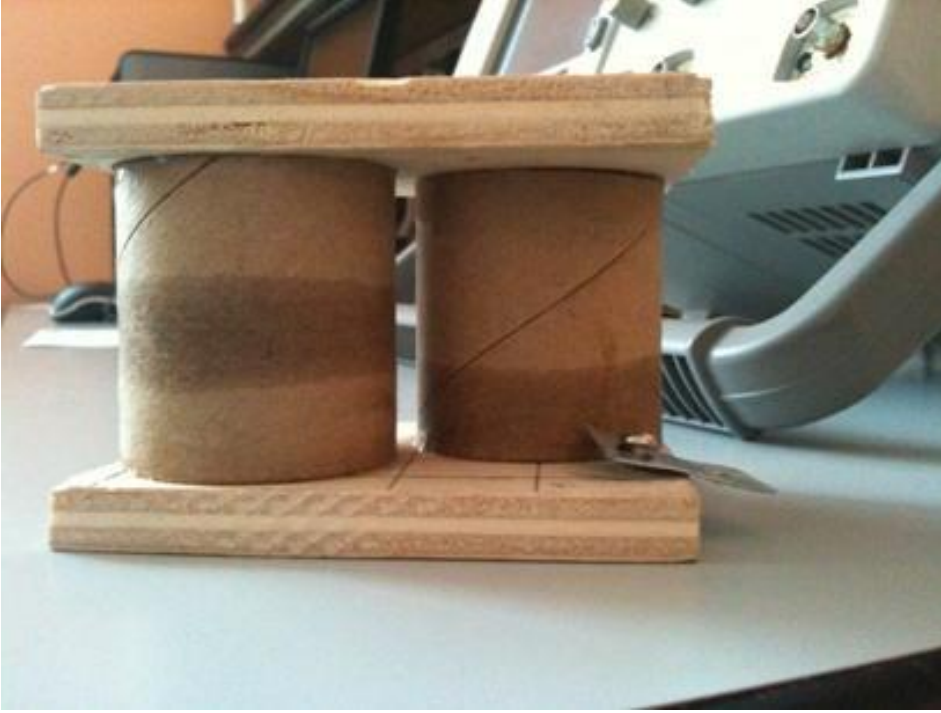
Şekil 3.9. Mandrel sarma testinde kullanılan donanım
