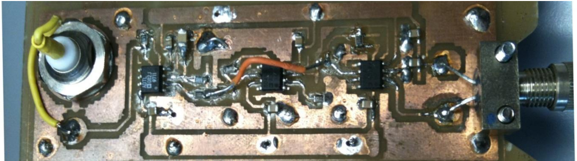
Şekil 4.6. Nefes sensörü baskı devre görüntüsü
