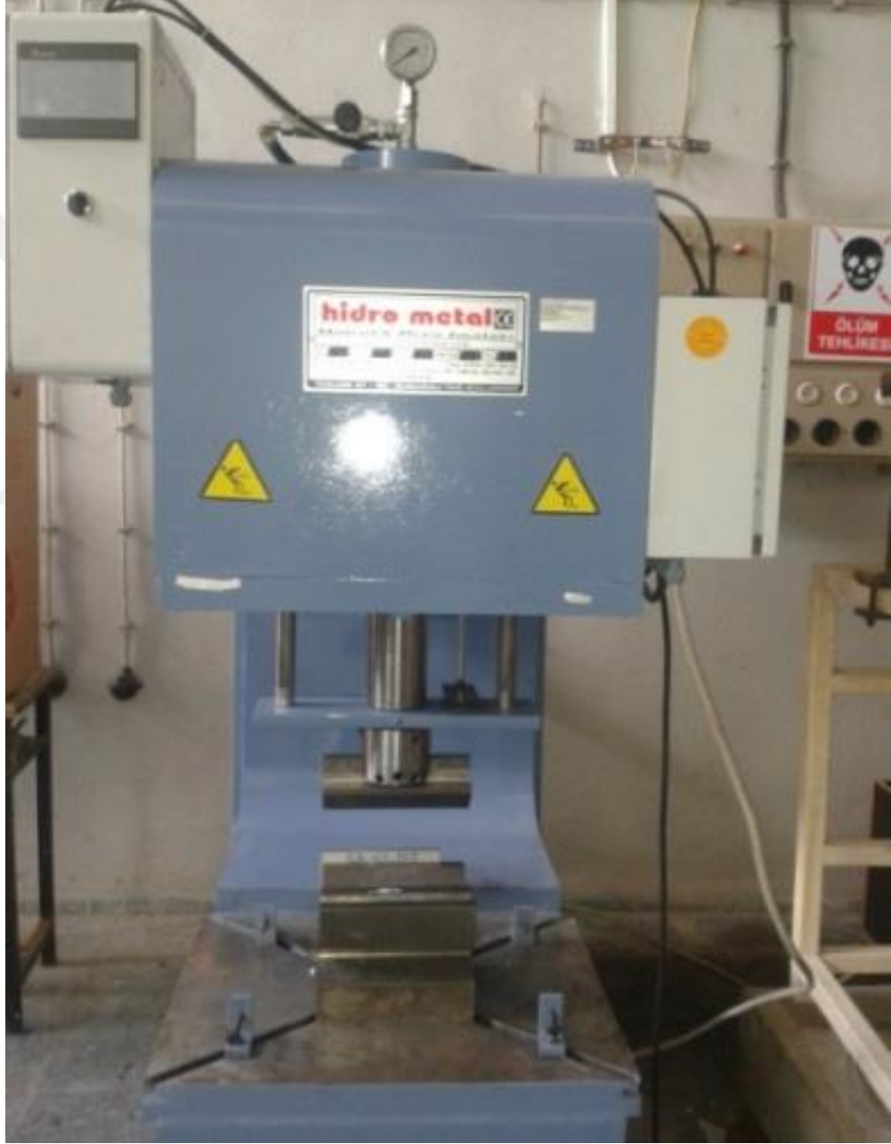
Şekil 3.9.(a) Hidrolik pres önden görünüm
