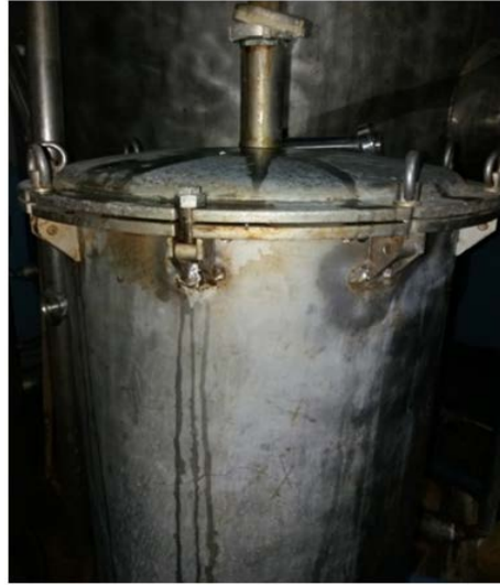
Ŗekil 4.4. 1 mikron por aplı kartuŖ filtrelerin bulunduđu hausing
