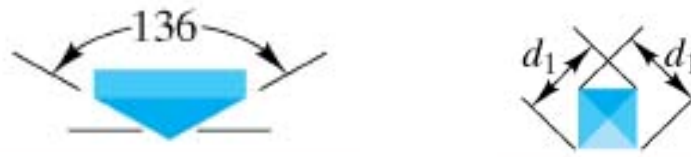
Şekil 2.7 Vickers Testi ( https://slideplayer.biz.tr/slide/2798476/ , erişim tarihi: 20.07.2020)
