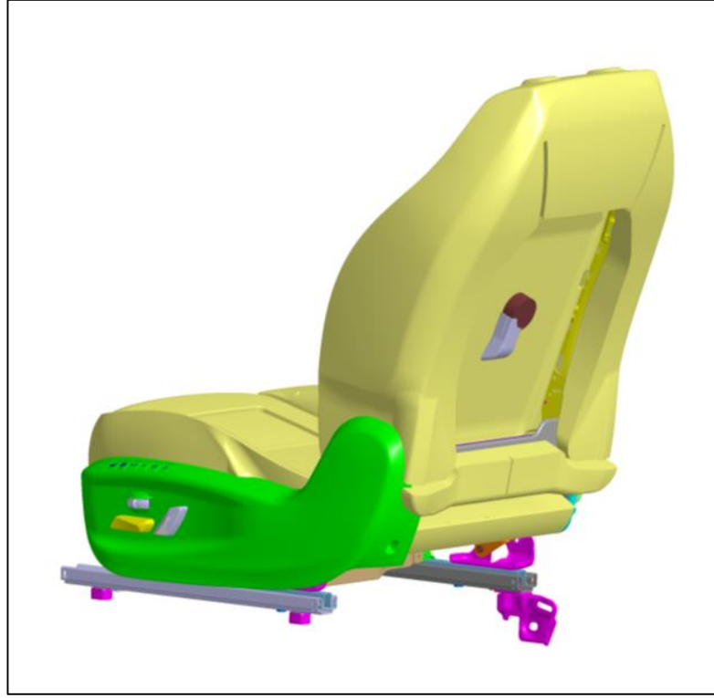
Şekil 3.2. Havalandırmalı koltuk tasarımı görseli.
