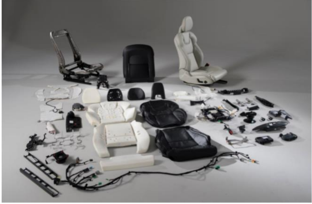
Şekil 3.1. Koltuk komponentleri ve koltuk tasarımı (Bhosale ve Vogt 2016)
