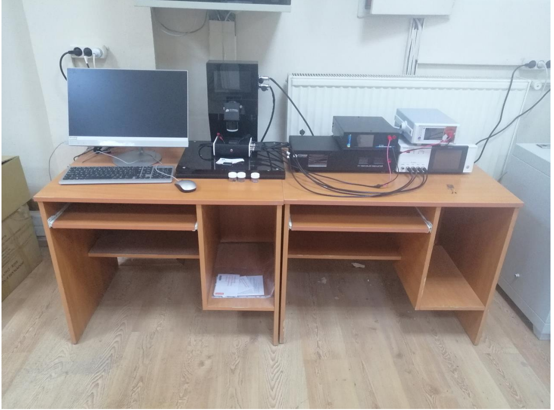
Şekil 3.7. CuS/ZnSe heteroeklemin I – V ölçümü yapılan sistemin genel görüntüsü (Fytronix 7000 SourceMeter ve Fy 7000 güneş hücresi simülatörü).
