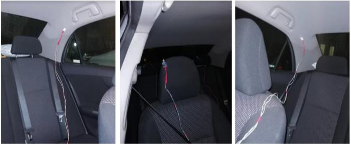
Şekil 3.6. Araç kabinine yerleştirilen sensörler
