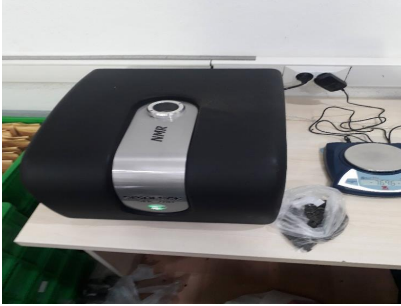
Şekil 3.4. Araştırmada yağ analizinde kullanılan NMR cihazı
