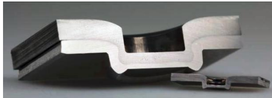
Şekil 2.8. 6+4 mm ve 1+1 mm sacların form punta kesiti (Israel ve ark. 2013'ten alınmıştır)
