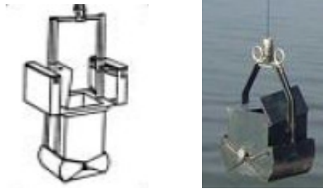
Şekil 3. 3. Ekman sediment örnekleyicisinin çizimi ve kullanımı sırasında çekilen fotoğrafı
