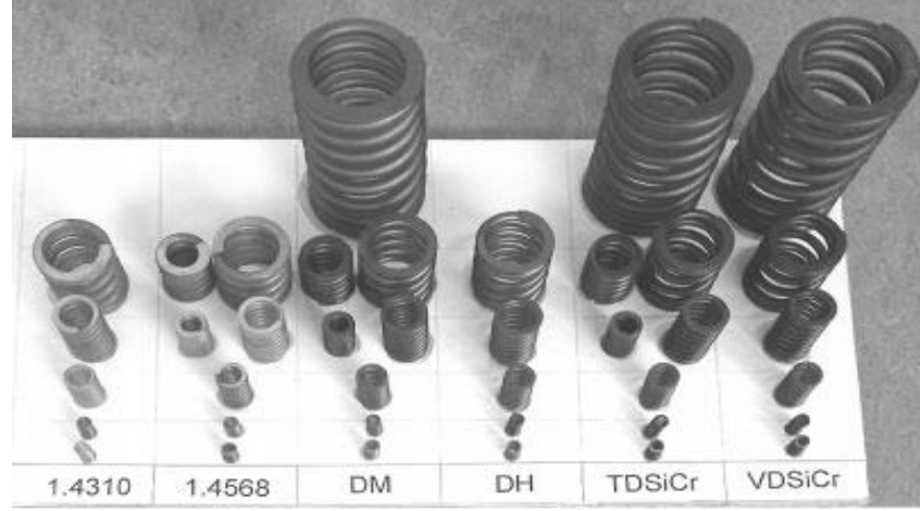
Şekil 2.25. Farklı malzemelerde 1, 2, 3, 5 ve 8 mm tel çaplarında helisel yay numuneleri (Kaiser ve Berger 2005)
