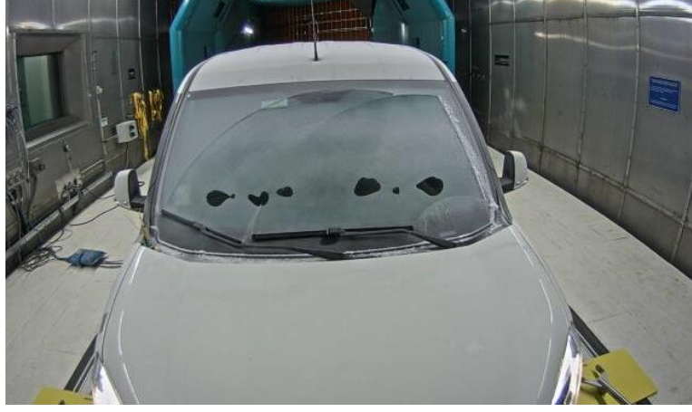
Şekil 4.41. Deney t=600 . saniye ön cam buz çözünme oranı
