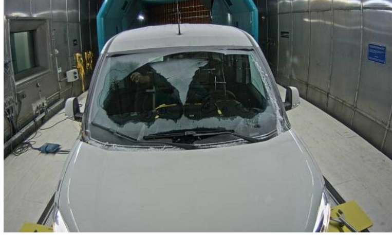
Şekil 4.44. Deney t=1500 . saniye ön cam buz çözünme oranı
