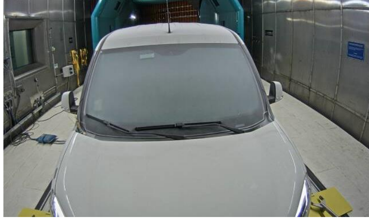
Şekil 4.39. Deney başlangıcı t=0 . Saniye ön cam buz çözünme oranı
