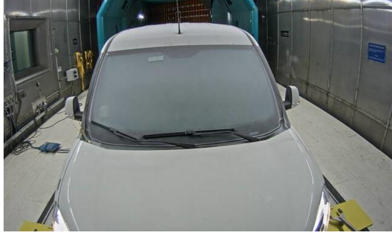
Şekil 4.40. Deney t=300 . saniye ön cam buz çözünme oranı
