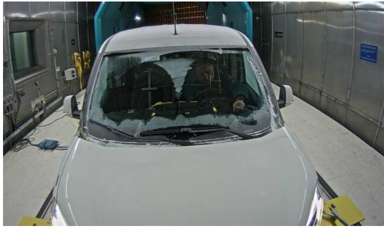
Şekil 4.45. Deney t=1800 . saniye ön cam buz çözünme oranı
