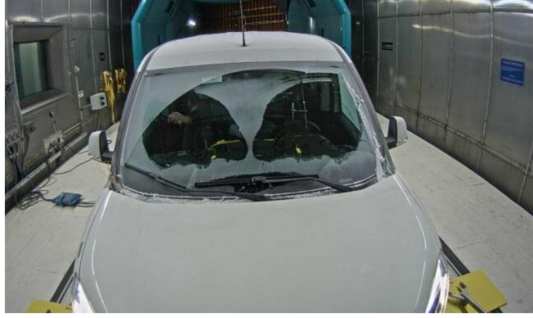
Şekil 4.43. Deney t=1200 . saniye ön cam buz çözünme oranı
