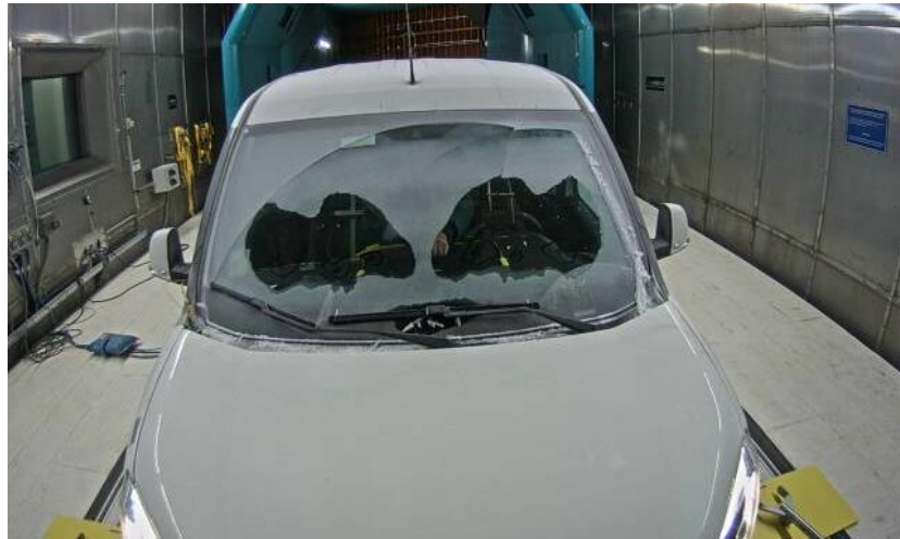
Şekil 4.42. Deney t=900 . saniye ön cam buz çözünme oranı
