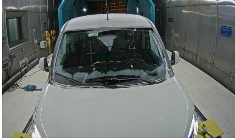
Şekil 4.46. Deney t=2100 . saniye ön cam buz çözünme oranı
