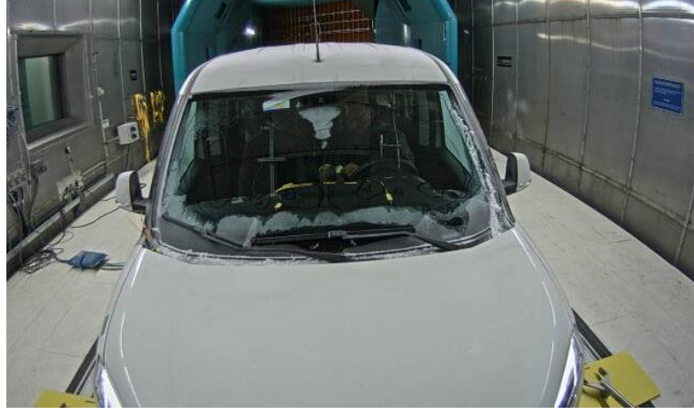
Şekil 4.47. Deney t=2400 . saniye ön cam buz çözünme oranı
