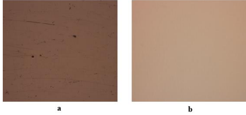
Şekil 3.5. Üretimi yapılan LED çiplerinin a) temizlik öncesi b) temizlik sonrası mikroskop görüntüsü.
