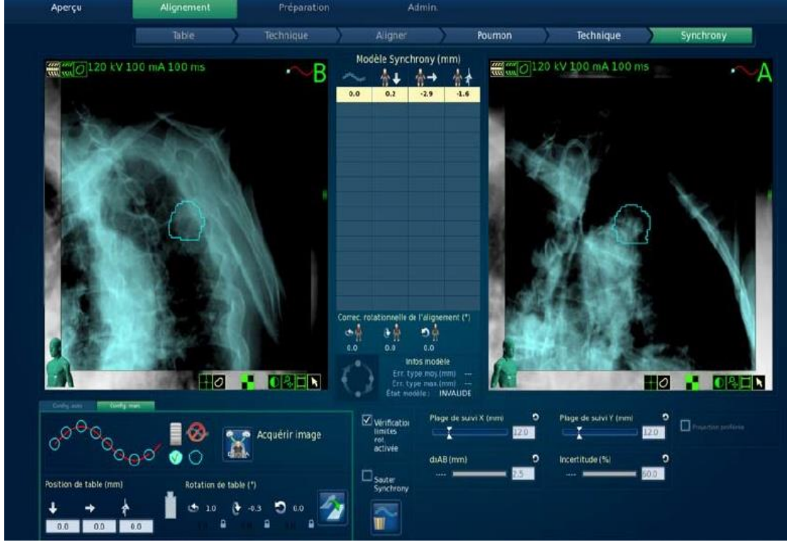
Şekil 12. X-Sight akciğer izleme algoritması (Accuray Inc., 2018)
