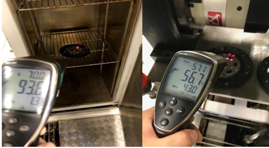
Şekil 3.39. Lazer termometre ile metalik yaylı ve elastomer yaylı debriyaj disk kompleleri için fırın testleri ve sıcaklık ölçümleri
