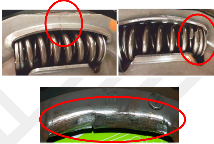
Şekil 3.49. Metal yaylı debriyaj disklerinde görülen dezavantajlar: a) kılavuz kırığı b) yay kırığı c) kılavuz aşınması
