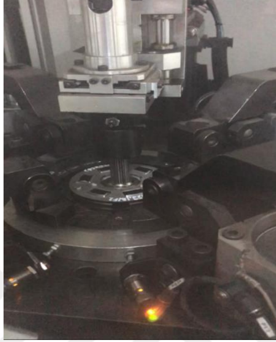
Şekil 3.21. Debriyaj diski damper torku ölçüm makinası
