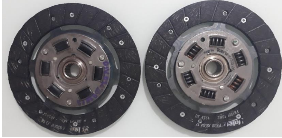
Şekil 3.34. Testlerde kullanılan örnek elastomer yaylı ve metalik yaylı debriyaj diski kompleleri
