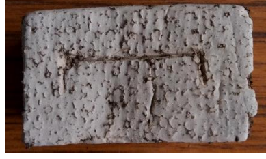
Şekil 4.2. Çentik açılmış numunenin pişmiş hali
