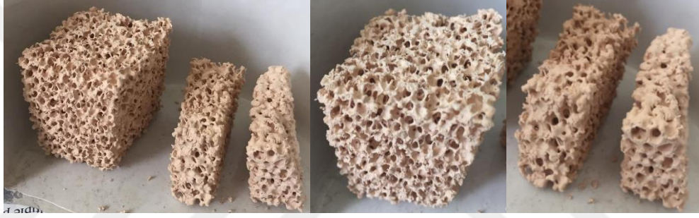
Şekil 4.3. Cidarları seramik kaplanmış ve pişirilmiş numunelerin birkaçı
