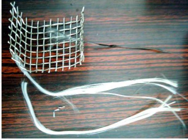
Şekil 3.11. U şekline getirilmiş örgü tel ve kullanılan fiber cam elyaf ve karbon elyaf iplikler
