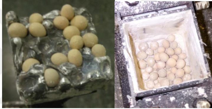
Şekil 4.5. Yer tutucular üzerine katı alüminyum bırakılarak yapılan deney
