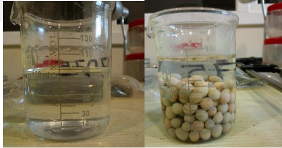
Şekil 3.10. Dökümde kullanılacak içi dolu seramik yer tutucu bilyelerin hacim hesabının yapılması
