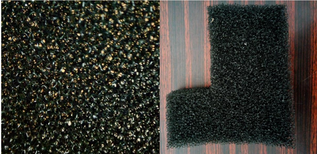
Şekil 3.2. 7-8 ppi poliüretan numuneleri: Soldaki ince kesit; sağdaki blok halde
