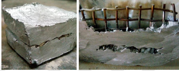
Şekil 4.7. Karbon fiber ve cam elyaf boşluk tutucular üzerine yapılmış döküm
