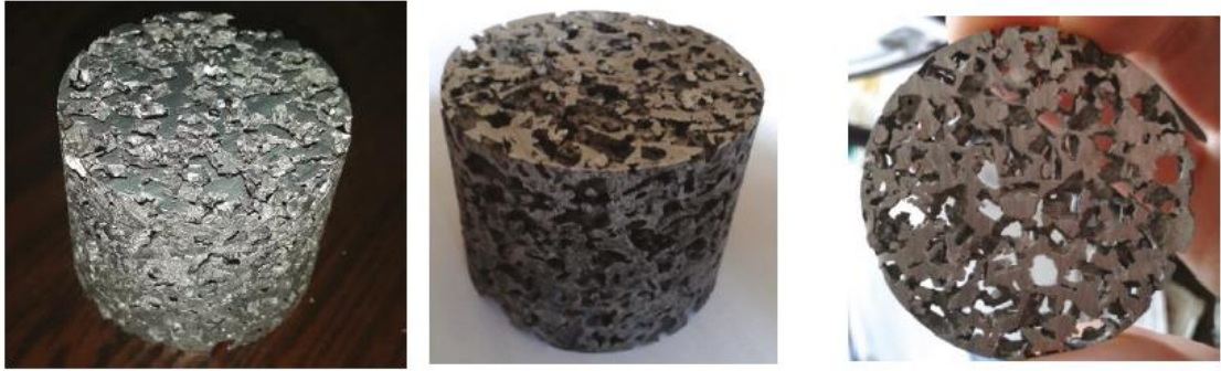
Şekil 2.15. Yer tutan malzeme yerine tuz kullanılmış numune; ilk görsel tuzdan arındırılmamış haline aittir (Varyoz ve ark. 2015)
