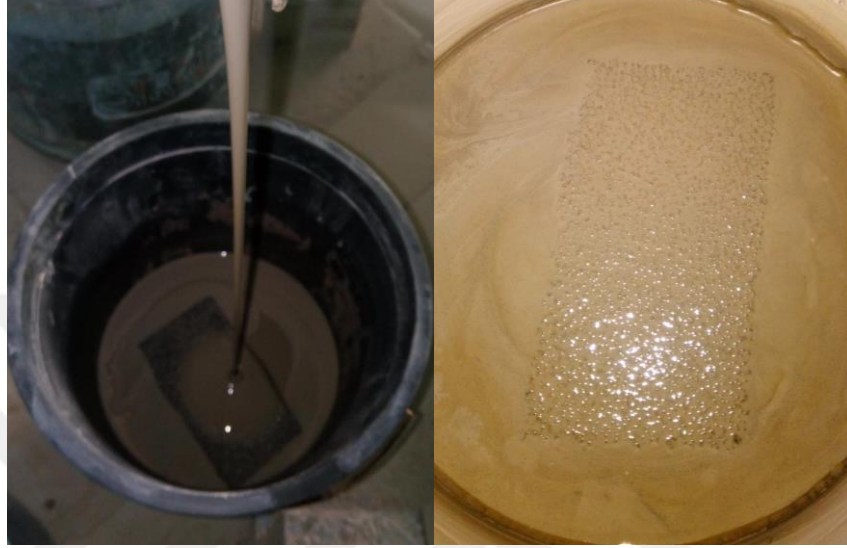
Şekil 3.3. Poliüretan köpüğün seramik çamur içerisine batırılması ve ezilerek havasının alındığı hali
