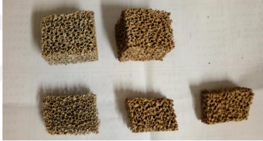
Şekil 3.7. Çeşitli cidar kalınlıklarında çamura bulanıp kurutulmuş numunelerin bir kısmı
