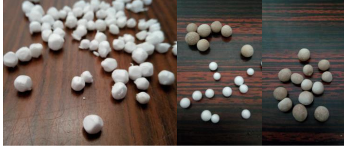
Şekil 3.9. Kullanılan küresel yer tutan elemanlar sırasıyla; poligonol strafor topları, strafordan tamamen küresel kar topları ve çamura kaplanmış halleri, seramik toplar
