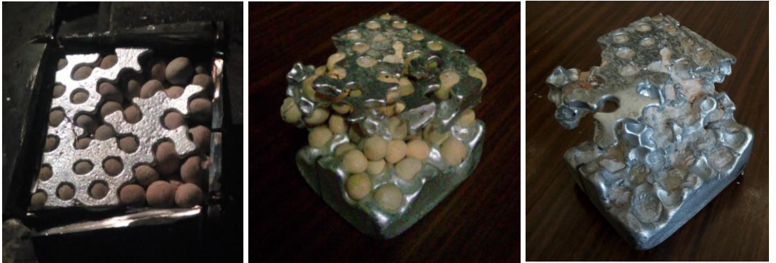
Şekil 4.6. Üzerine ergimiş alüminyum dökülmüş küresel boşluk tutucular
