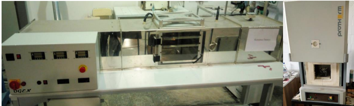
Şekil 3.4. Kullanılan ekipmanlar: Soldaki kalıbın kurutulmasında kullanılan kurutma fırını; Sağdaki Protherm'in PLF 130/9 modelli 3600 watt 1300°C çıkabilen fırını
