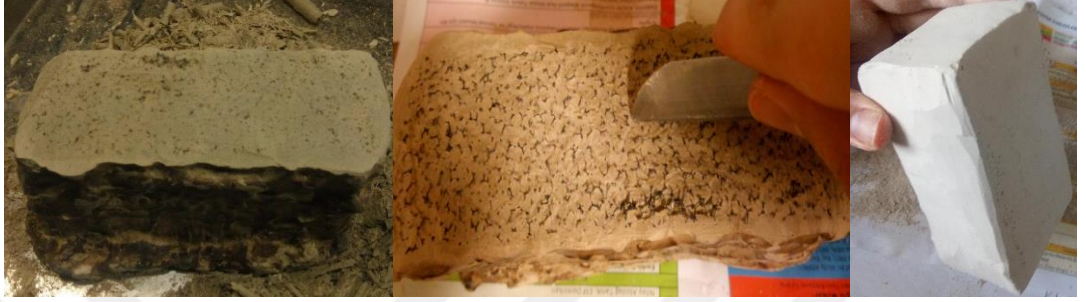
Şekil 3.5. Kurumuş kalıptan polimer köpüğün uçlarının çıkarılması
