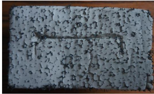
Şekil 3.6. Çentik atılmış pişirilmeyi bekleyen numune
