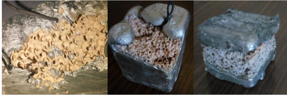
Şekil 4.4. Sırasıyla yanına dökülmüş, ergimiş metale daldırılmış ve üzerine alüminyum külçe bırakılmış numuneler
