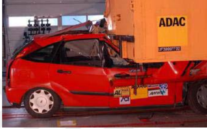
Şekil 2.20. 2006/20 / EC'ye uygun arka koruyucu ile ADAC çarpışma testinin sonucu (ADAC 2006)
