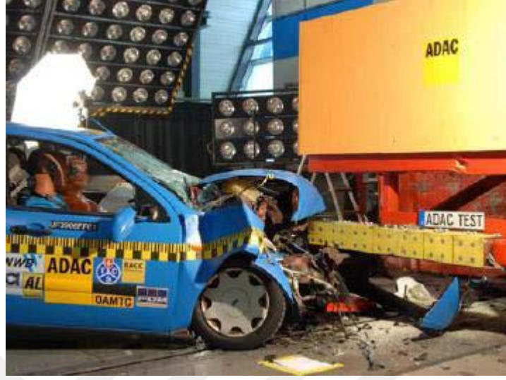
Şekil 2.22. Güçlendirilmiş ve alçaltılmış arka koruyucu ile 2. ADAC testinin sonucu (ADAC 2006)
