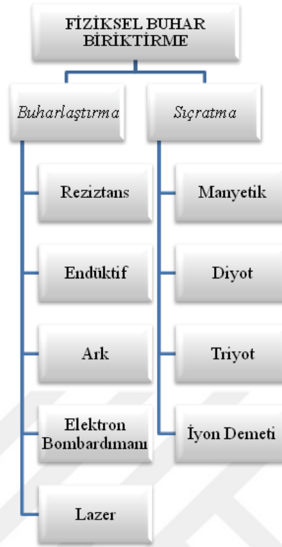
Şekil 2.7. Fiziksel buhar biriktirme teknikleri (Sönmezoğlu ve ark., 2012)
