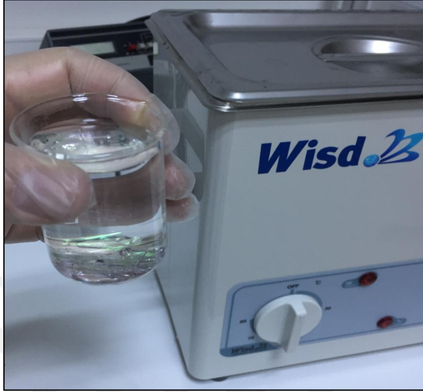
Şekil 3.1. Deney öncesinde ITO camlarımızı ultrasonik temizleme aşaması
