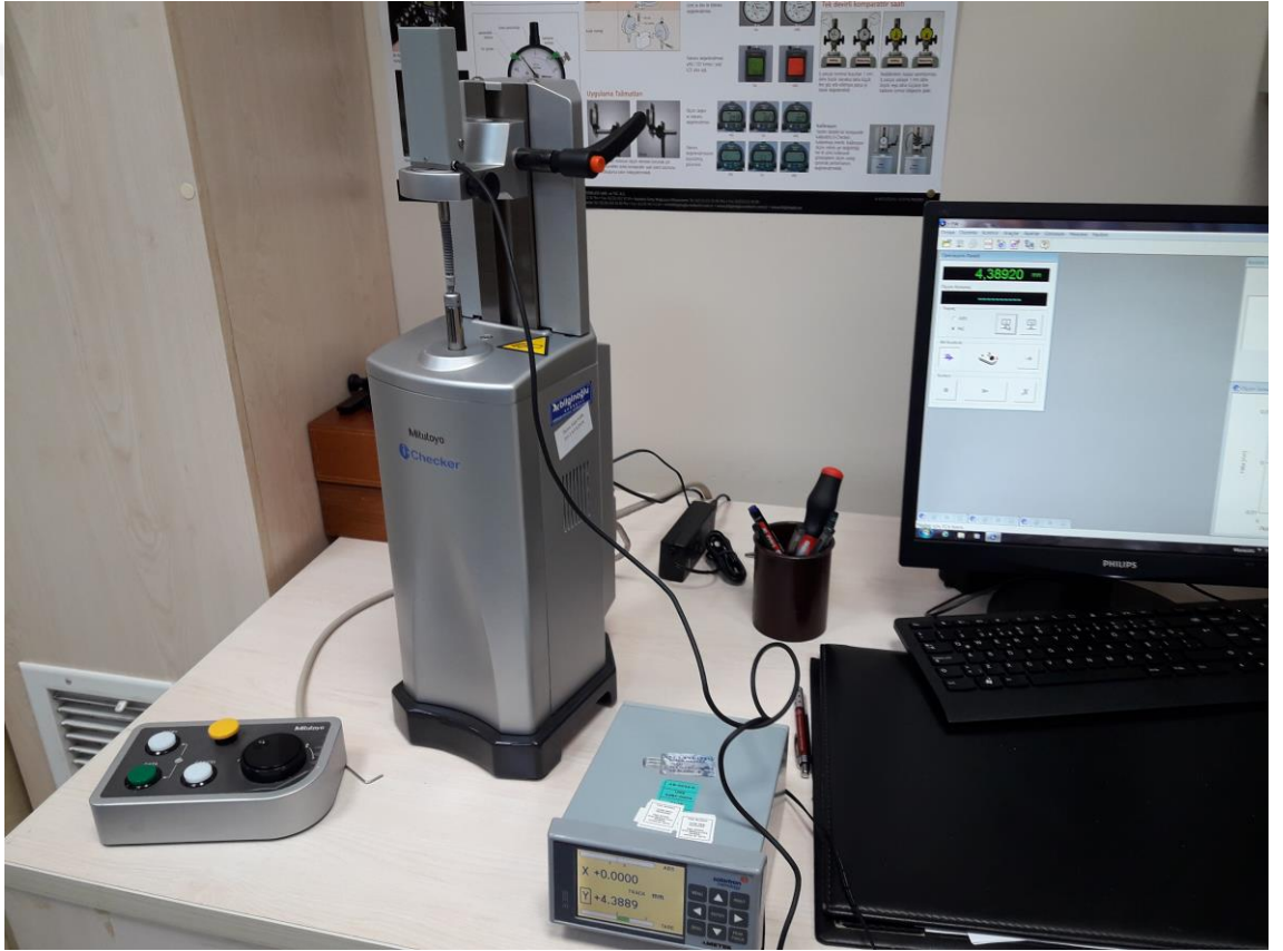
Şekil 3.12. Ölçme saati test cihazı referans ölçme probu ile kalibrasyonu
