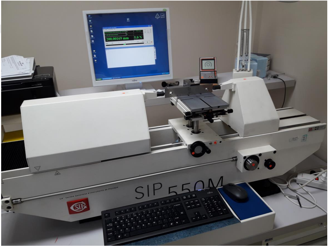
Şekil 3.10. Universal uzunluk ölçüm cihazı referans P.B.M seti ile kalibrasyonu
