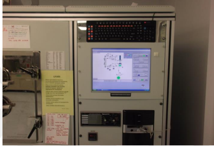
Şekil 3.1. Omik kontakın gerçekleştirildiği termal evaporator.
