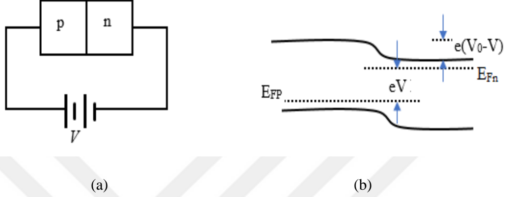
Şekil 2.6. (a) Bir p-n eklemine uygulanan V ileri besleme gerilimi, (b) enerji bant diyagramı
