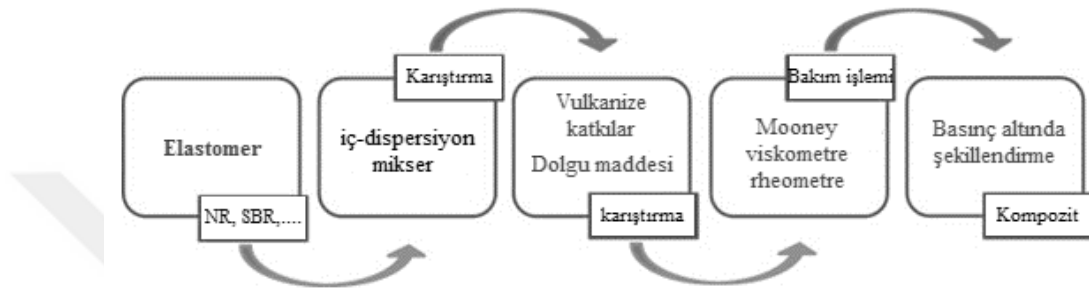
Şekil 3.1. Malzemenin üretme aşamaları (Papageorgiou ve ark. 2015'ten değiştirilerek alınmıştır)
