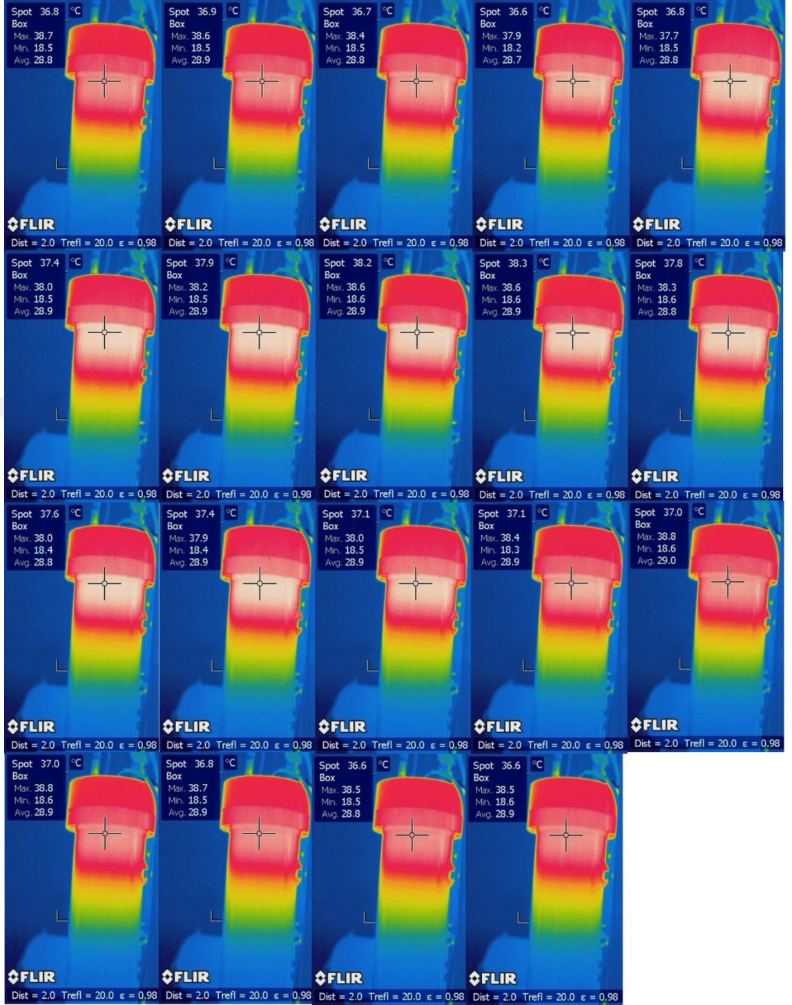
Şekil 4.28. Sıkıştırma sürecinde bir strok boyunca sıvı pistonlu hava sıkıştırma silindiri yüzey sıcaklıkları
