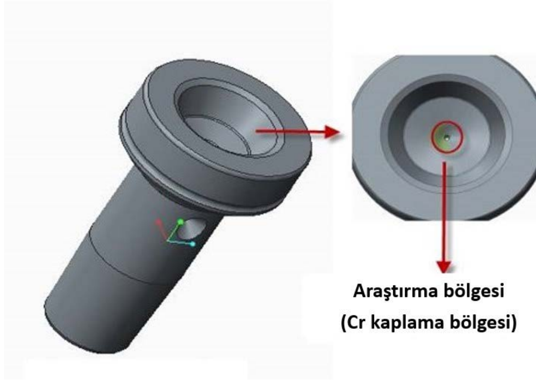
Şekil 2.3. CRI2-16 OHW enjektörüne ait valf parçası ve üzerinde çalışılacak bölge (Bosch)
