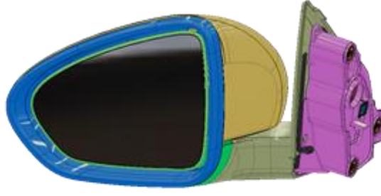
Şekil 3.12. Sanal ortamda tasarlanmış bir dış dikiz aynası
