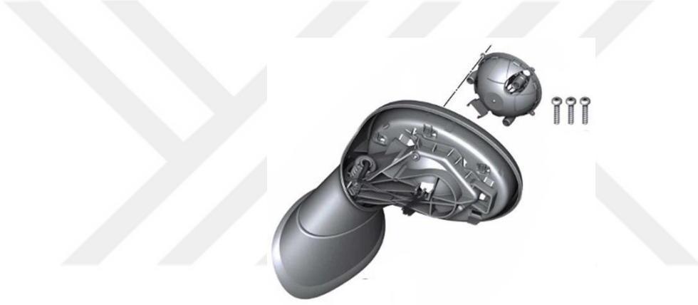
Şekil 3.8. Dış dikiz aynası ve cam ayar motoru
