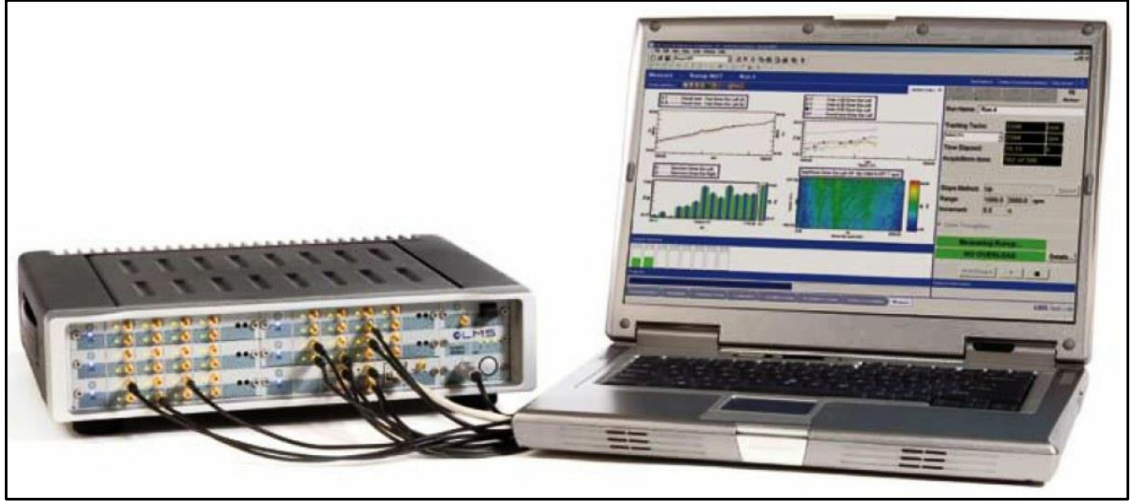
Şekil 3.28. Data toplayıcı, bilgisayar, Test Lab programı (LMS SCADAS)
