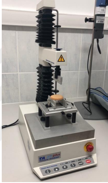
Şekil 3.5. Bisküvide tekstür ölçümü
