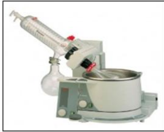
ekil 3. 15. Döner buharla tırcı (Laborota 4001 model, Heidolph, Almanya)
