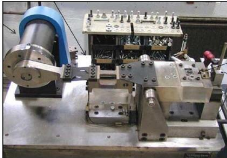
Şekil 33. Zwickau Üniversitesi civata çözülmesi araştırma standı (Çavdar 2014)
