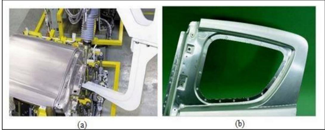
Şekil 2.17. Mazda RX-8 spor arabasının kapı sacı ve gövde sacı üzerinde yapılan SKNK uygulamasına ilişkin örnekler; (a) gövde paneli ve (b) yan kapı panelidir (Tunçel 2015’den alınmıştır)
