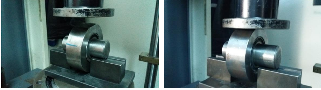
Şekil 4.3. Radyal katılık testleri görseli
