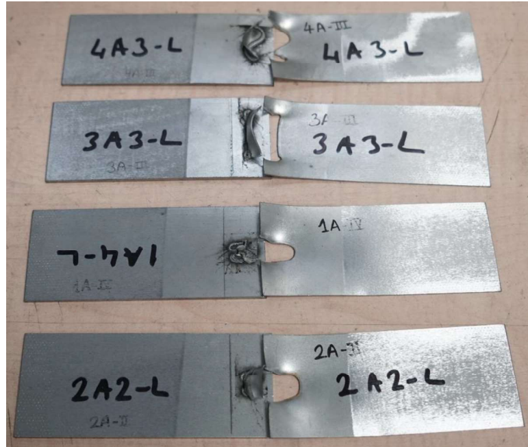
Şekil 4.10. Bindirme tipinde birleştirilen numunelerin çekme testi sonrası görüntüleri
