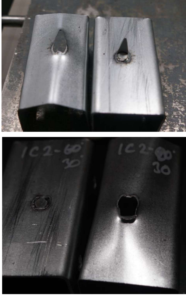
Şekil 4.16. KS-II tipinde birleştirilen numunelerin çekme testi sonrası görüntüleri
