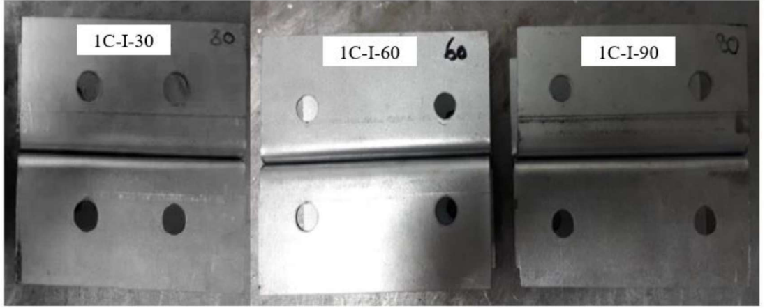
Şekil 3.17. C tipi dikiş geometrisi ve KS-II birleştirme tipiyle hazırlanan örnek numuneler
