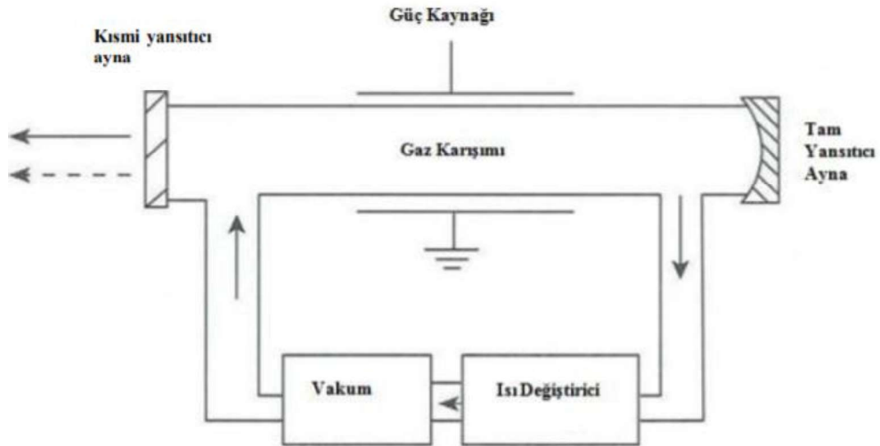
Şekil 2.8. Gaz lazeri şematik gösterimi (Arcan, 2011)
