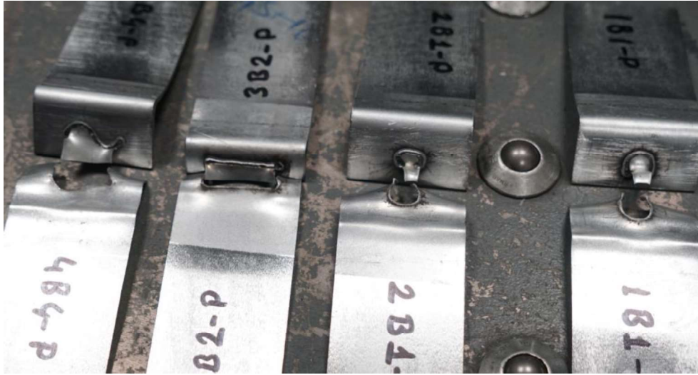
Şekil 4.12. Peel tipinde birleştirilen numunelerin çekme testi sonrası görüntüleri
