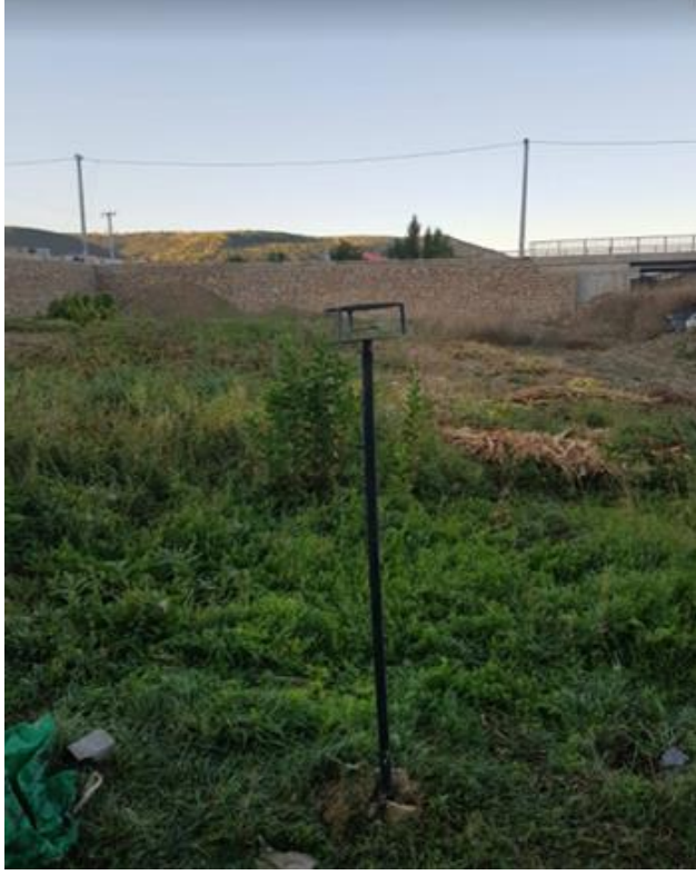
Şekil 3.4. Çalışmada kullanılan Durham cihazı ve yeri
