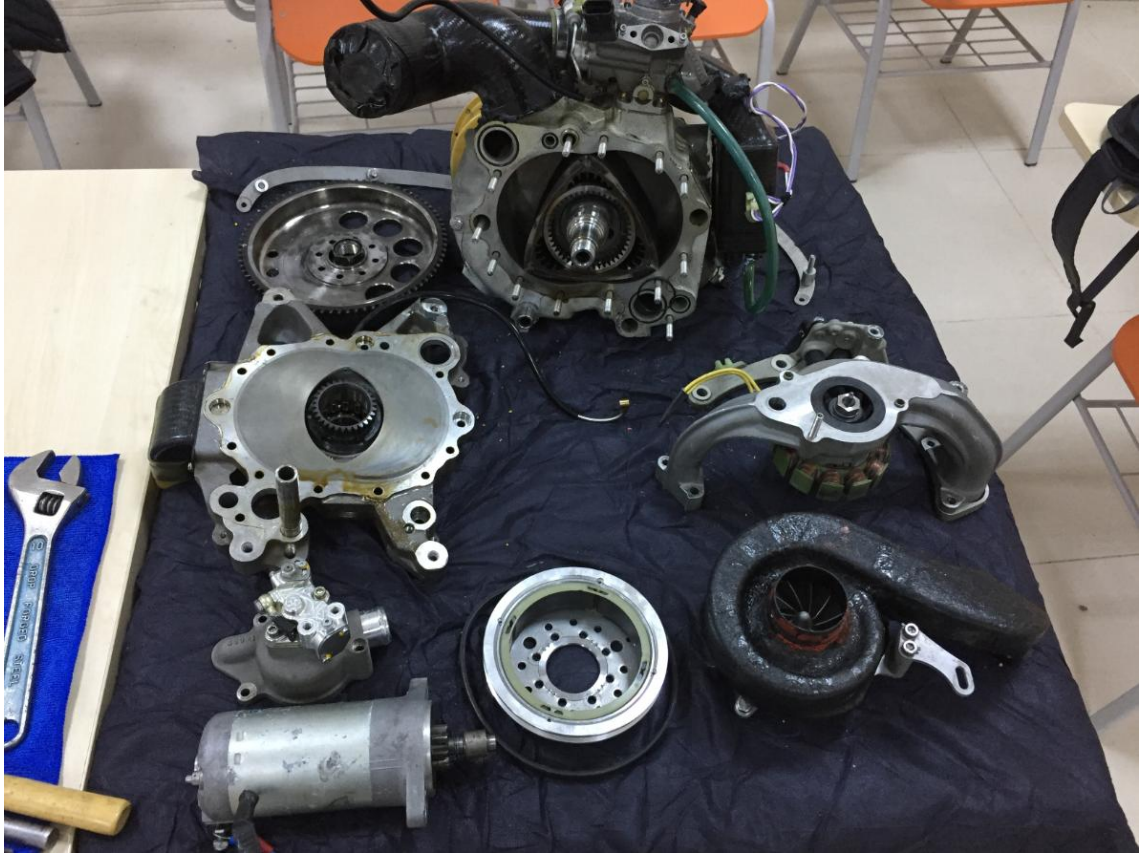
Şekil 3.2. Parçaları çıkartılmış wankel motoru genel görüntüsü
