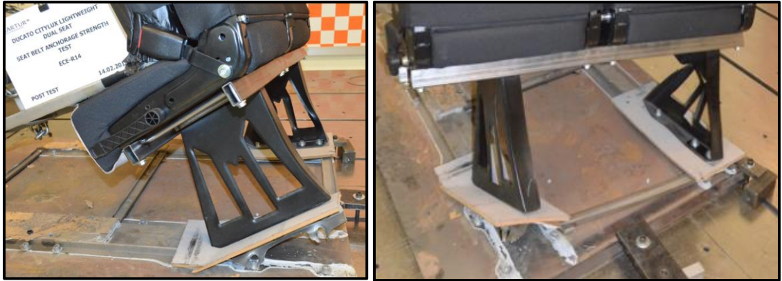
Şekil 4.17. ECE R14 Emniyet kemer testinin sonrası ayak bağlantılarının test sonrası görünümü
