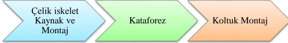
Şekil 5.1. Çelik iskeletli koltuk üretim akışı
