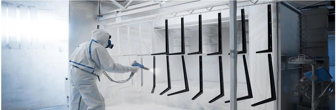
Şekil 5.6. Elektrostatik toz boyama prosesi
