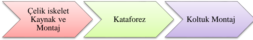
Şekil 5.3. Çelik iskeletli koltuk üretim akışı
