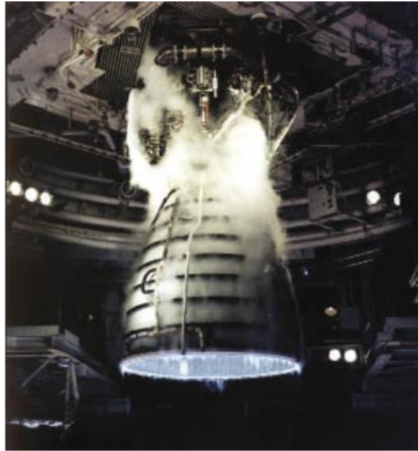
Şekil 2.9. Rocketdyne tarafından yapılan bir uzay mekiği ana motoru (NASA Technical Anonimous, 2011)
