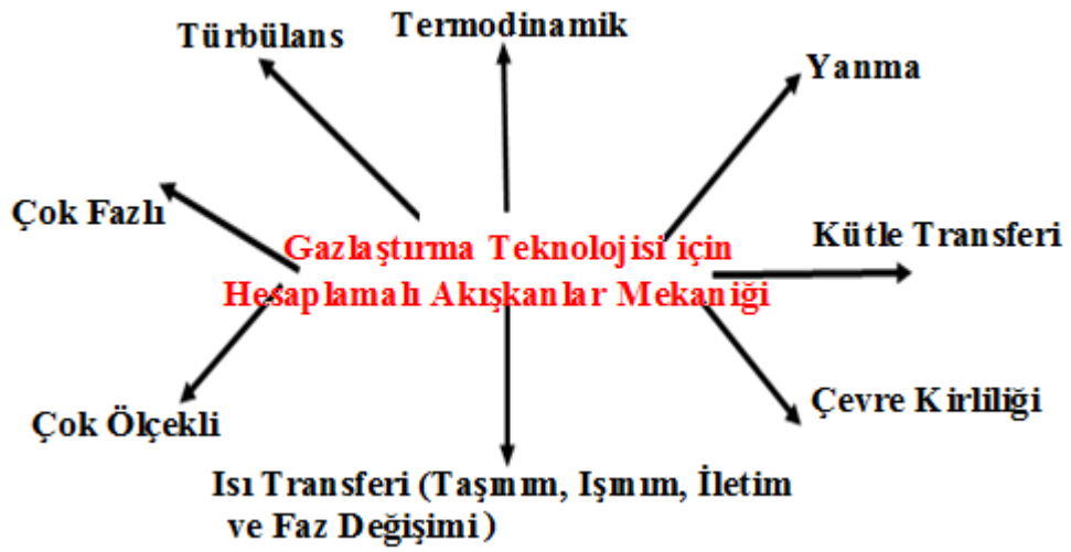
Şekil 3.18. Gazlaşma fiziksel ve kimyasal olayları.
